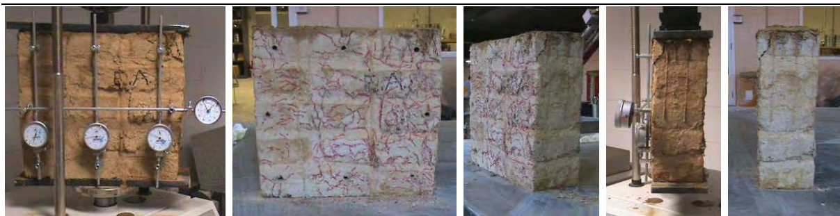
Fig. 51 - Prismas de Kraftterra após ensaios de resistência à compressão simples. Este prisma passou por ciclos de envelhecimento acelerado.
