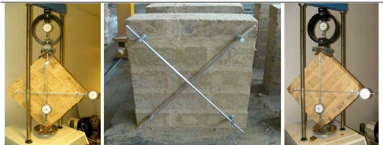
Fig. 31 - Sistema de fixação de barras e apoios para extensômetros em prismas para realização de ensaios de compressão diagonal.
