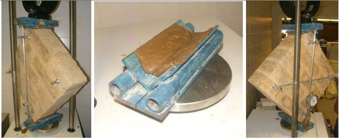
Fig. 32 – Colocação de argamassa de solo para melhor acomodação dos apoios metálicos responsáveis pela distribuição dos esforços de compressão.
