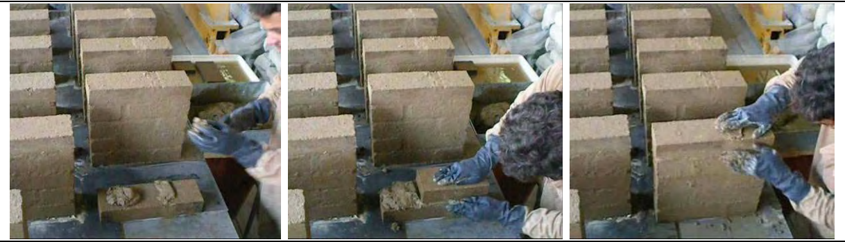
Fig. 26 – Execução de prisma com BTCs e argamassa de assentamento de Kraftterra feito com as mãos, sem o uso de colher de pedreiro. Detalhe da imersão dos BTCs em água (esq.).
