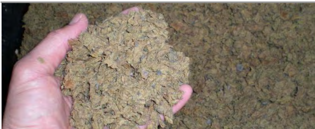
Fig. 6 – Presença de pedriscos de cimento endurecido entre as fibras dispersas após processo de reciclagem onde os restos de cimento não foram retirados previamente dos sacos.
