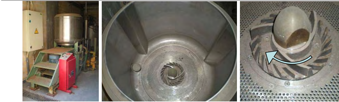
Fig. 7 – Misturador de papel da RAIZ / Vista do interior do tanque / Detalhe da hélice com sentido de rotação.
