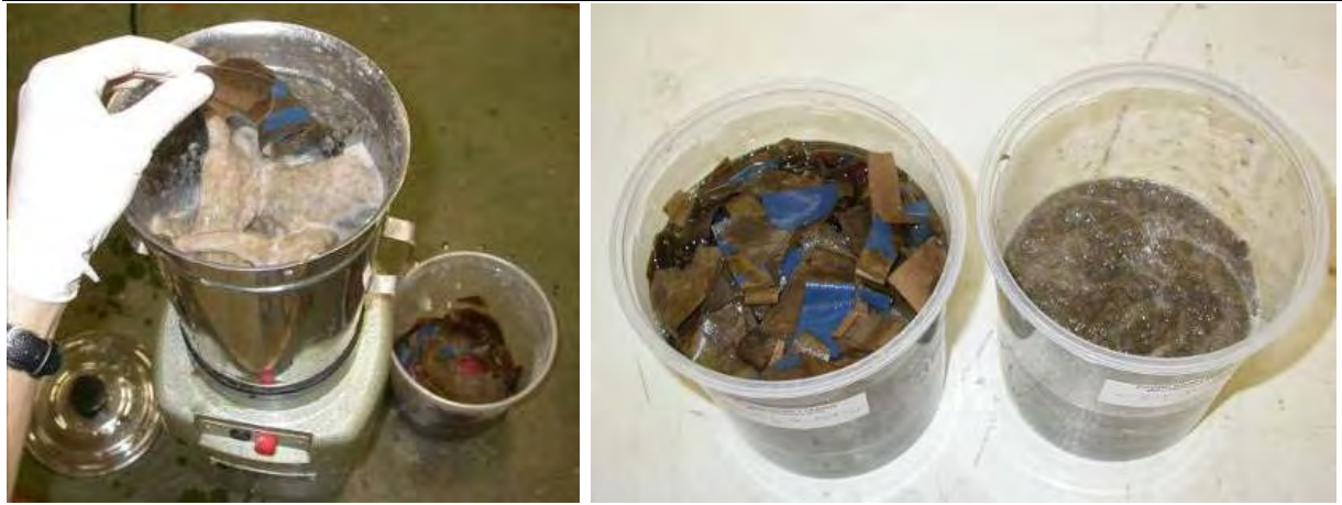
Fig. 4 – Trituração do papel em liquidificador industrial (esq.); Kraft fragmentado de molho e polpa de celulose ao final do processo (dir.).
