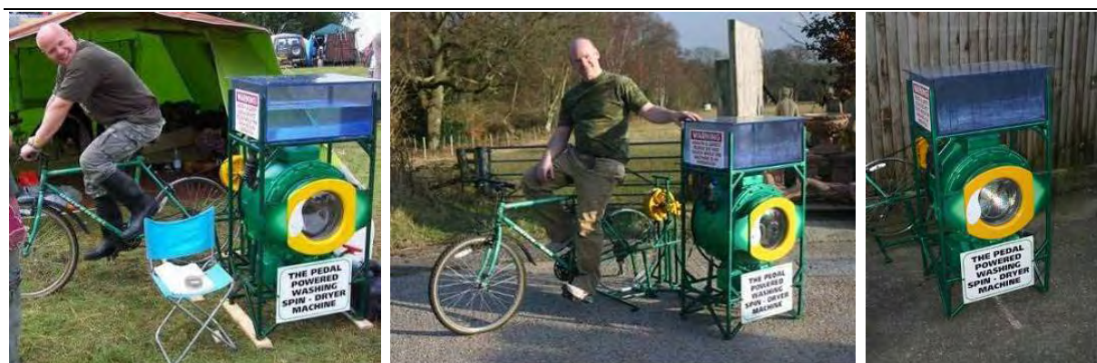
Fig. 11 – Lavadora e secadora de roupas movida à bicicleta. Projeto “Cycleclean” desenvolvido por Alex Gladson (Fonte: http://www.cycleclean.biz/mainmenu.html , 2009).
