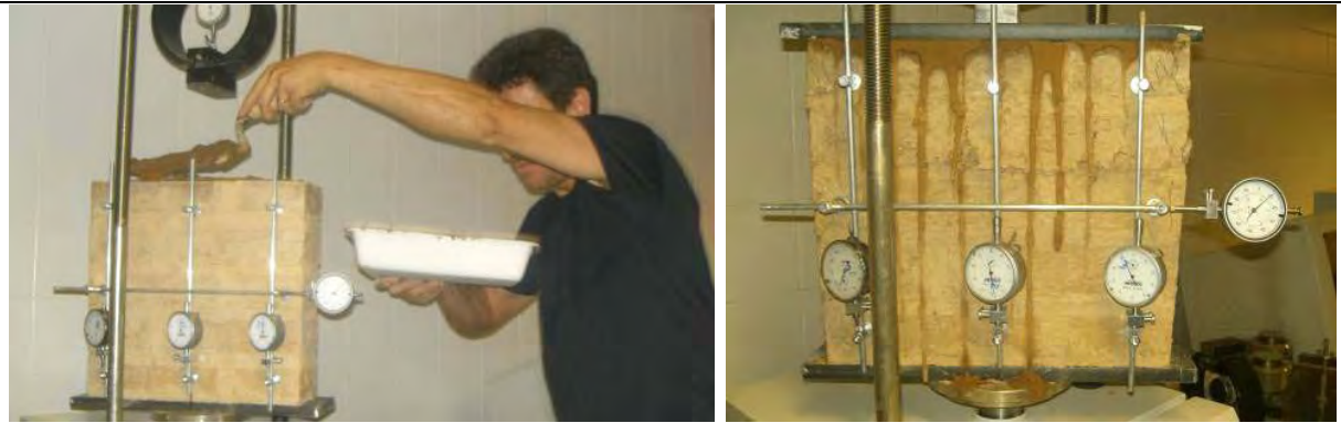
Fig. 30 - Colocação de argamassa de solo para melhor acomodação da chapa metálica responsável pela distribuição dos esforços de compressão simples.
