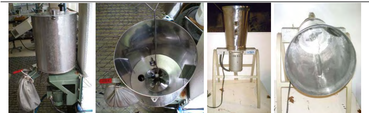
Fig. 5 – Misturador com dreno no copo (esq.); Liquidificador com copo reclinável para retirada do material (dir.)
