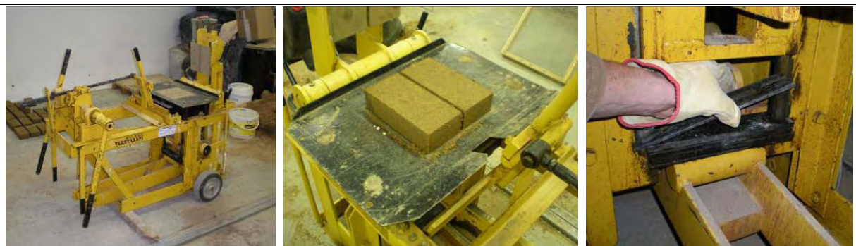
Fig. 20 – Prensa TERSTARAM para produção de BTCs. Detalhe do sistema de ajuste de altura do molde (dir.).
