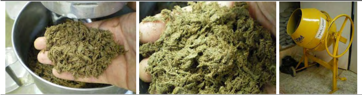
Fig. 16 – Kraftterra sendo misturado em argamassadeira (esq.); Detalhe do início do processo de mistura do Kraftterra (centro); Betoneira portátil (capacidade 80 litros) para misturar o Kraftterra para uma pequena escala de produção de BTCs (dir.).
