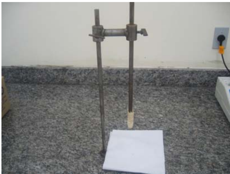
Figura 2 – Mecanismo gerador da lesão por impacto segundo modelo de FILHO e colaboradores (2006).
