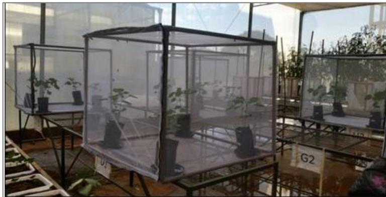
**Figura 2.** Gaiolas utilizadas no teste de não-preferência para oviposição com chance de escolha, confeccionada por tubos de PVC e revestidas por tecido tipo “tule” com abertura na parte frontal e fechamento com tiras de velcro. No interior foram confinadas plantas contendo os tratamentos com *B. thuringiensis* expostas à oviposição por *S. frugiperda*.
