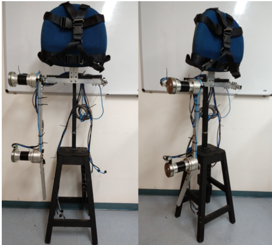
Figura 1 – Exosqueleto de membro inferior desenvolvido pelo grupo GRACO/UnB.
