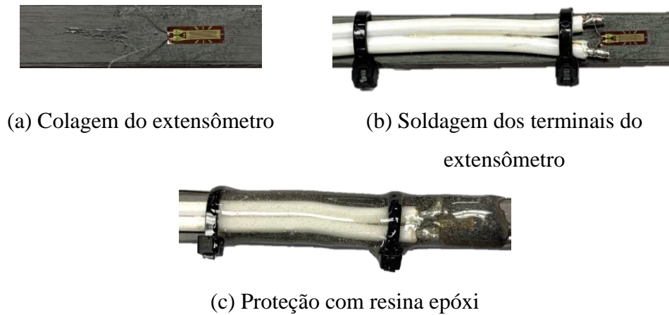
Figura 3.20: Posicionamento dos extensômetros no laminado de PRFC.
