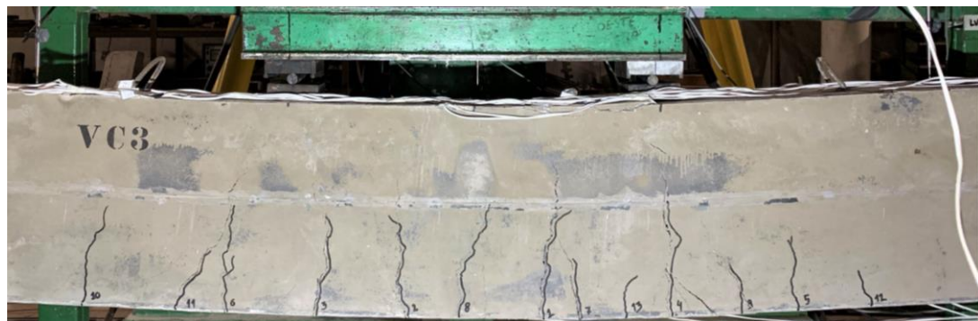
Figura 4.3: Vista frontal do trecho central da viga VC3 após o ensaio.
