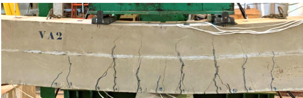
Figura 4.6: Vista frontal do trecho central da viga VA2 após o ensaio.
