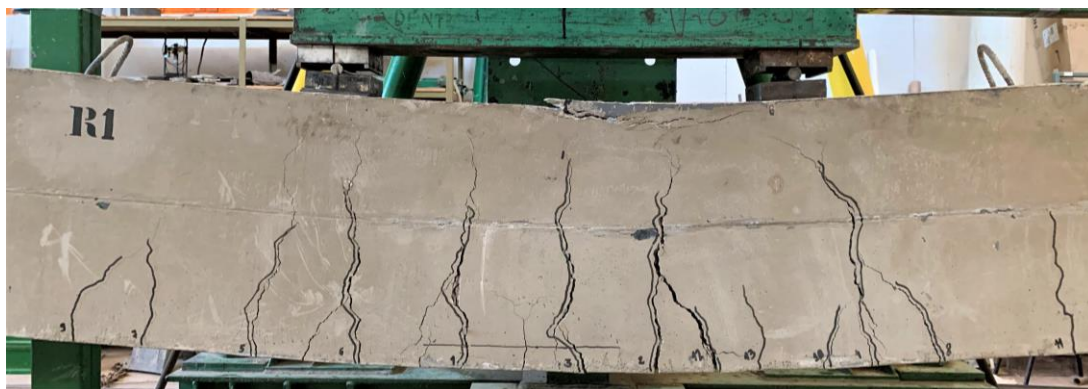
Figura 4.1: Vista frontal do trecho central da viga VR1 após o ensaio.
