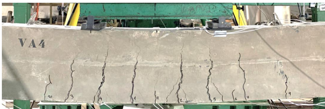
Figura 4.8: Vista frontal do trecho central da viga VA4 após o ensaio.
