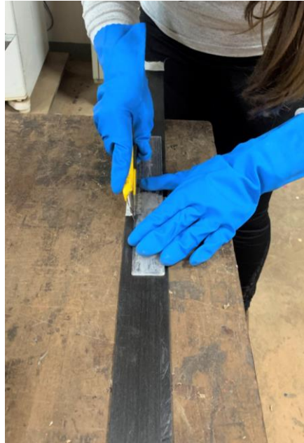
Figura 3.29: Corte do laminado para obtenção de tiras de 10 mm de largura.
