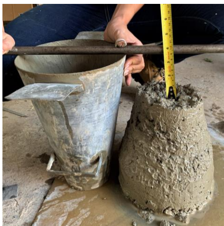
Figura 3.11: Resultado do ensaio de determinação da consistência do concreto pelo abatimento do tronco de cone.
