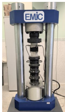
Figura 3.14: Ensaio de determinação do módulo de elasticidade do concreto.
