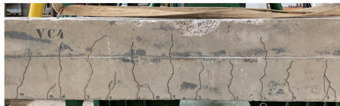
Figura 4.4: Vista frontal do trecho central da viga VC4 após o ensaio.
