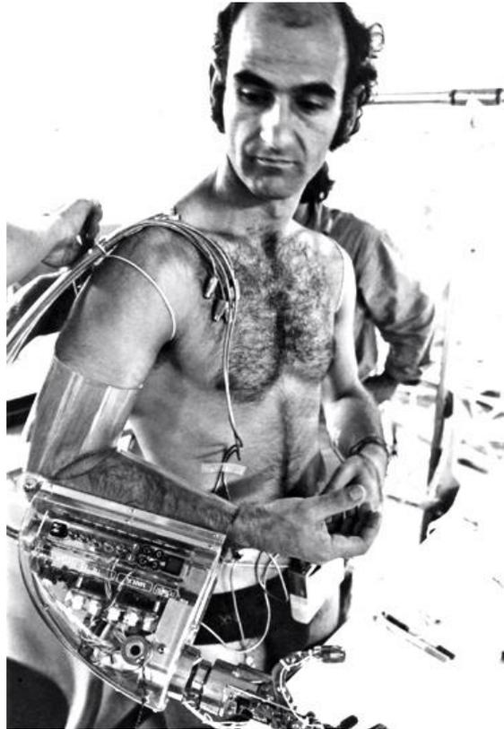
Figura 9 Captura de imagem do experimento *Third hand* usado em performance por Stelarc, terceiro braço mecânico feito de alumínio, aço inox, acrílico, látex, eletrodos, cabos e bateria e incorporado ao corpo. Fonte: <http://stelarc.org/?catID=20265>
