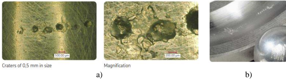
Figura 2 - Ilustração de microdefeitos superficiais em pista de rolamento, onde a) apresenta microdefeitos da ordem de 500 µm em rolamento autocompensador de rolo submetido a uma corrente elétrica excessiva e b) mostra erosão na pista e na esfera de um típico rolamento rígido de esferas (SKF, 2017).
