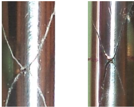
Figura E12 - Imagens das trincas geradas após falha dos corpos de prova submetidos a carregamento de fadiga torcional alternada. Carregamento em torno do eixo longitudinal do espécime. Imagens obtidas por câmera digital, modelo Sony 14.1.
