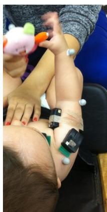
Figura 12: Ilustração do posicionamento dos marcadores reflexivos para análise cinemática e eletrodos de EMG em membro superior do lactente no momento da avaliação. (Fonte: Próprio autor.)
