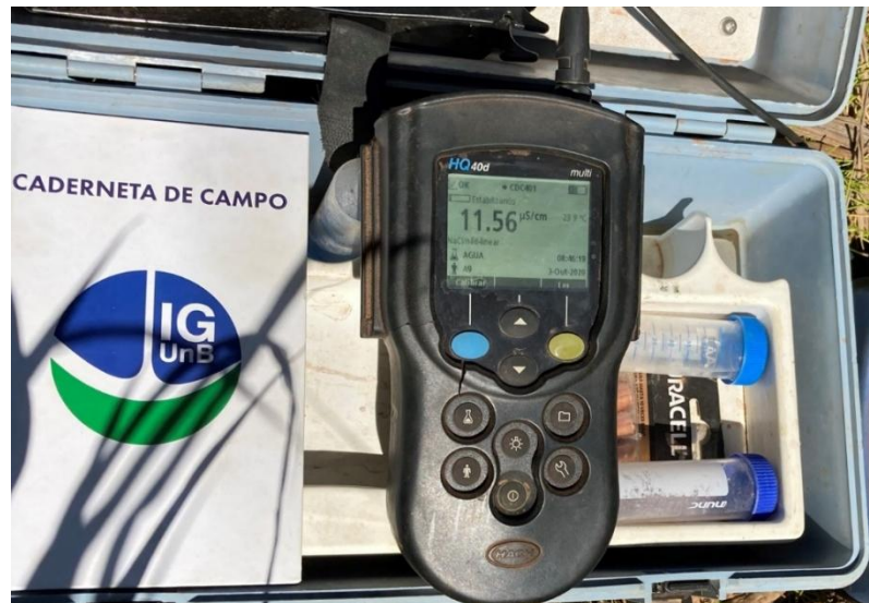
Figura 1.2 - Sonda Multiparâmetro da marca Hach utilizada nos trabalhos de campo para as medições in situ de pH, temperatura (°C), Eh e condutividade elétrica ( \mu\text{S}/\text{cm} ).
