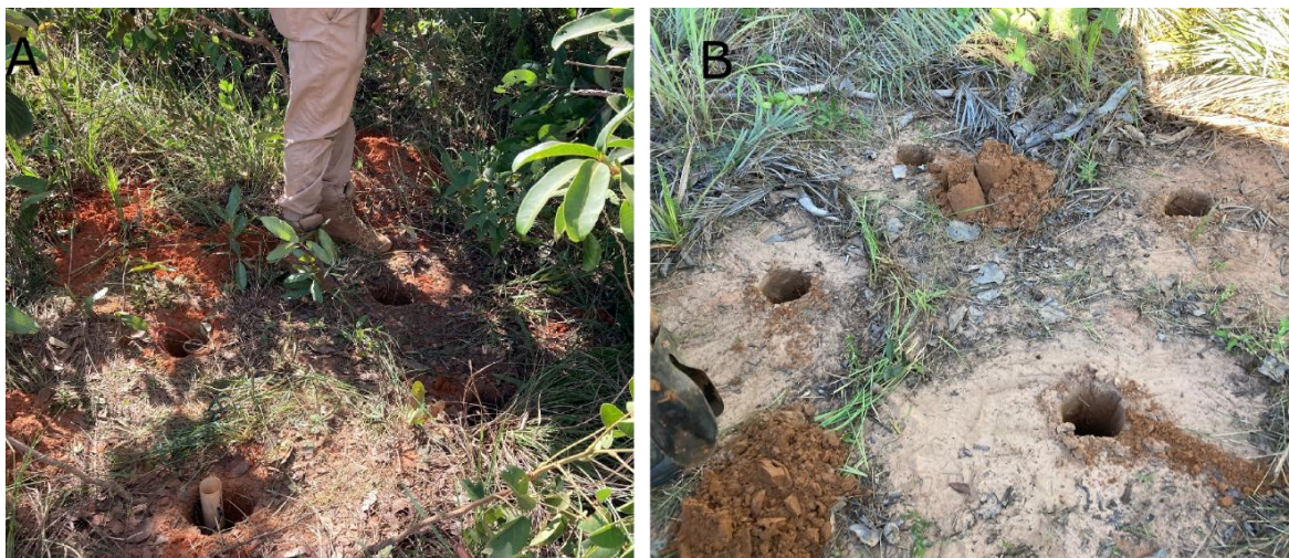
Figura 1.5 - Ilustração de campo durante realização de ensaio Open end Hole . Em ambos os casos estão representados os 4 furos necessários para cada ensaio, os quais foram realizados com escavadeira articulada e trado manual.
