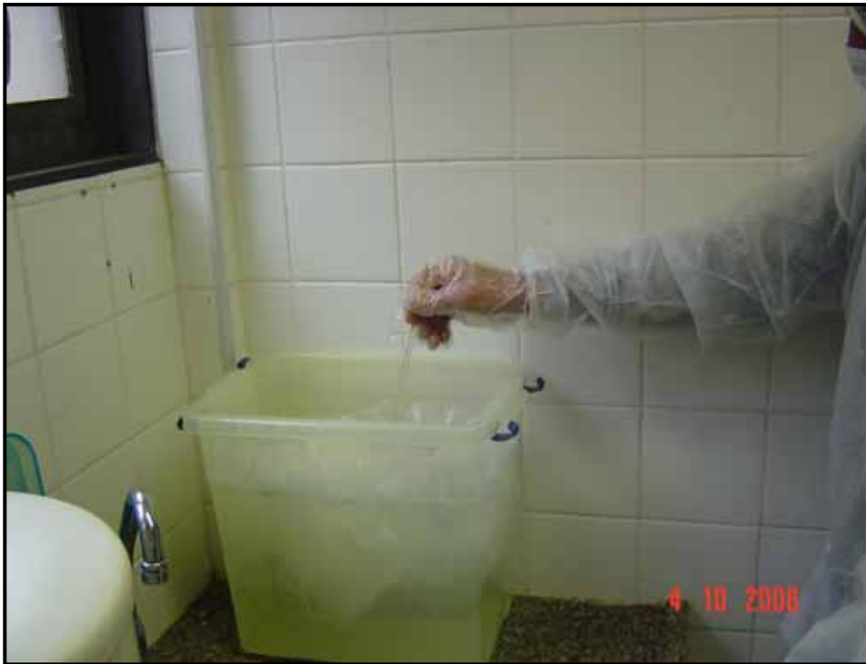
FIGURA – 5: Material para a coleta do leite materno sendo colocado na rinsagem em ácido nítrico 30%, com o cuidado de mantê-lo submerso na solução.
