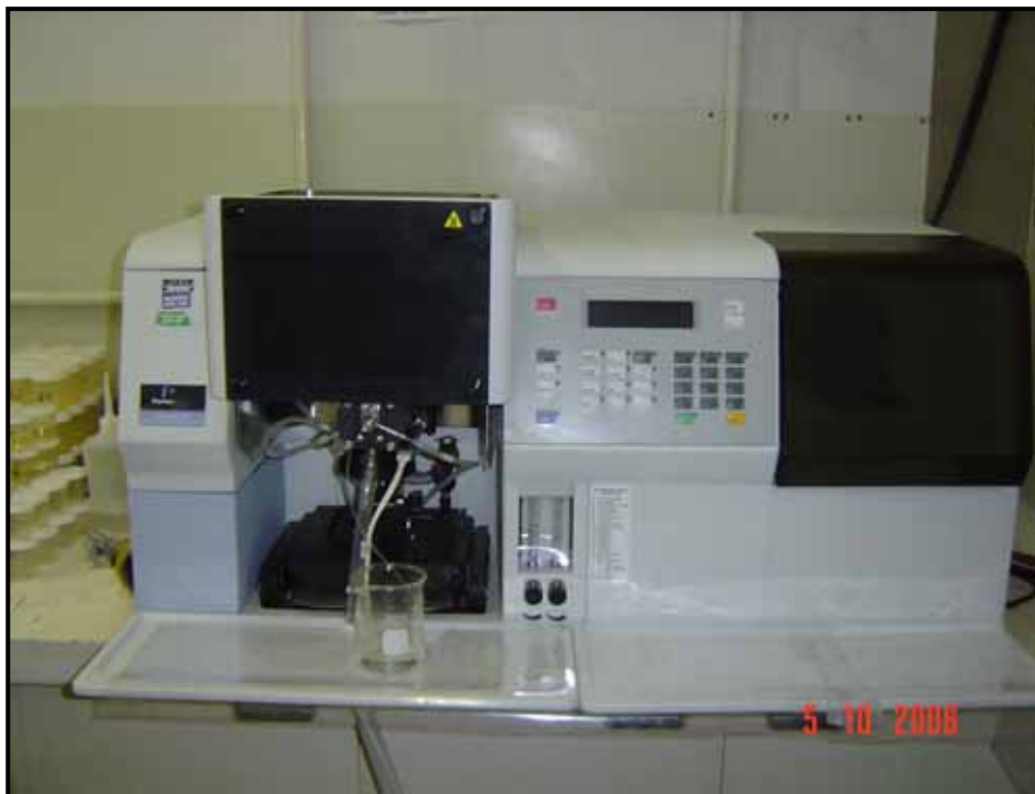
FIGURA – 15: Aparelho modelo Analyst 100, marca Perkin Elmer, utilizado para a análise da concentração de zinco e cobre.
