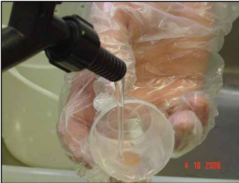
FIGURA – 7: Enxágue do material rinsado em ácido nítrico, em água ultrapura, para remoção de resíduos de ácido nítrico.
