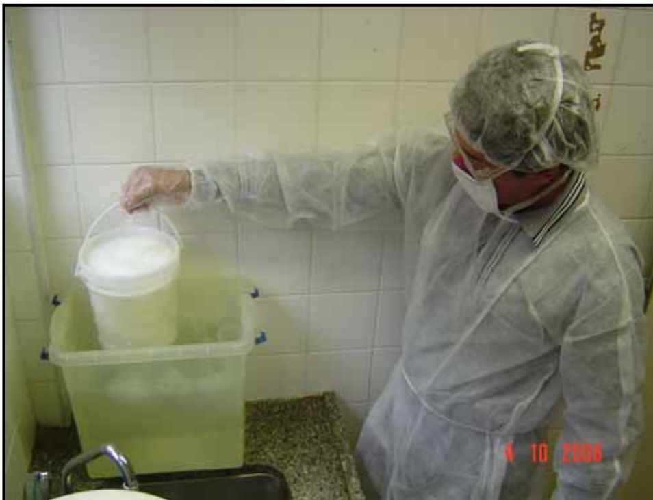
FIGURA – 6: Remoção do material da rinsagem em ácido nítrico, após 24 horas de espera, com escoamento de toda a solução antes do enxágue.
