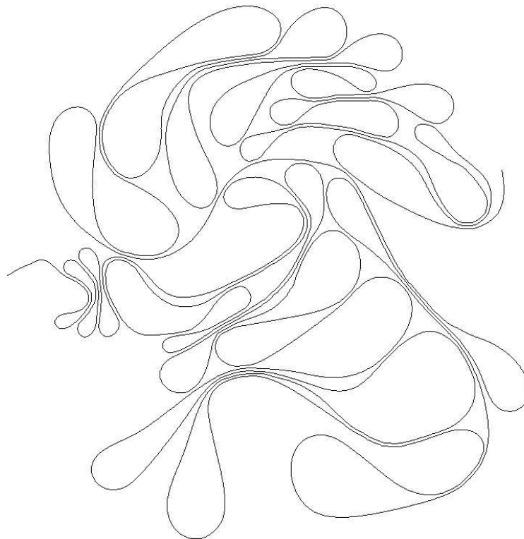
Figura 7.3: Configuração típica para fio de cobre no regime de máxima densidade de empacotamento, p_{max} \simeq 0,15 .
