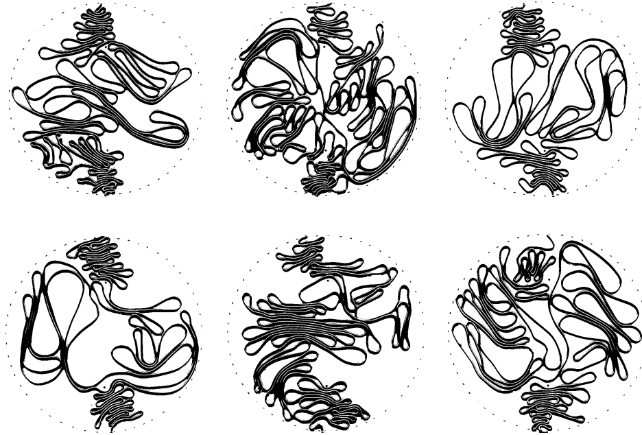
Figura 5.9: Arranjos de fios de solda empacotados com 2 pinos, com condição de contorno inicial para o fio passando pelos dois obstáculos paralelamente.
