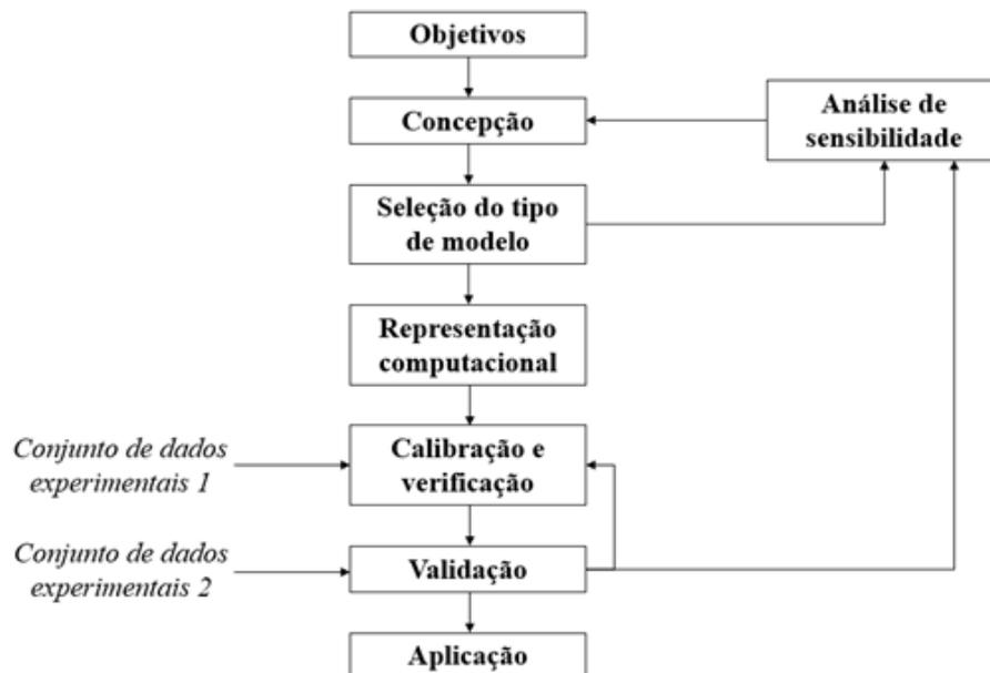
Figura 4 - Fluxograma das etapas de desenvolvimento de modelo matemático (adaptado de von Sperling, 2007)
