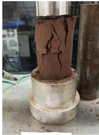
(b) “Rejeito + 20% Polímero” após ruptura
