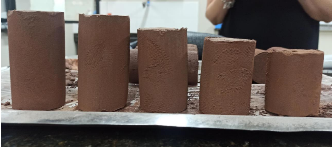
Figura 3.1 – Tentativa de Compactação
