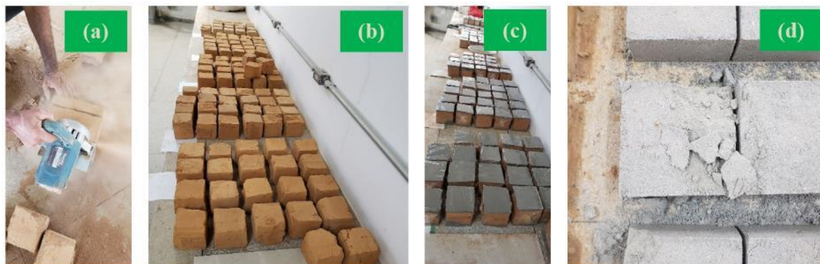
Figura 5. (a) Processo de corte dos prismas; (b) prismas cortados; (c) prismas cortados e capeados; (d) adobes com 100% de rejeito inviabilizados para ensaio de resistência à compressão
