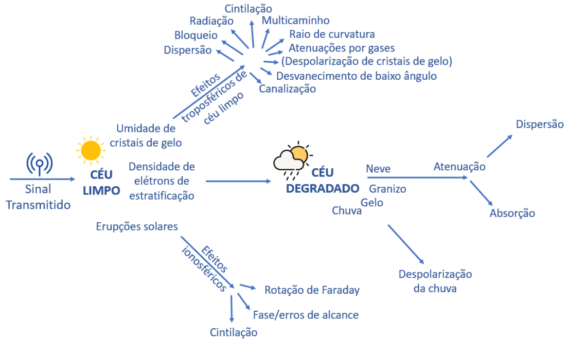
Figura 2.3 – Diagrama esquemático dos efeitos na propagação do sinal na atmosfera. Adaptado de [2].
