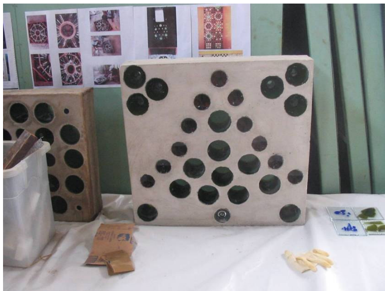
Fotografia 22 – Blocos Pré-Moldados de Vidro e Azulejos de Garrafas de Vidro Fundido Autor: Nepomuceno Data da foto: 2006
