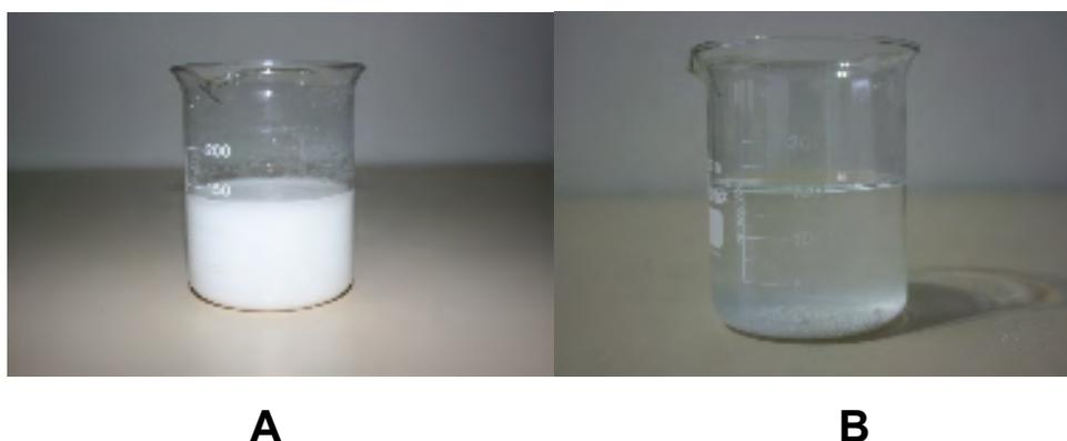
**Figura 34.**  $\text{TiO}_2$  anatase em suspensão (A). Nanotubos de titânia sedimentados (B).
