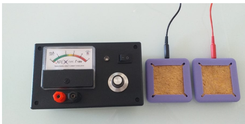
Figura 20. Aparelho de tDCS com esponjas(ânodo e cátodo). Fonte: aparelho utilizado na presente pesquisa.
