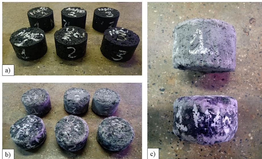
Figura 3.11 - Amostras compactadas no compactador Marshall submetidas ao ensaio Cantabro: a) Amostras antes do ensaio; b) Amostras após o ensaio; c) Nítida diferença do desgaste entre as misturas MAB-R30 (superior) e MAC (inferior), esta última com topo e base mais arredondados.
