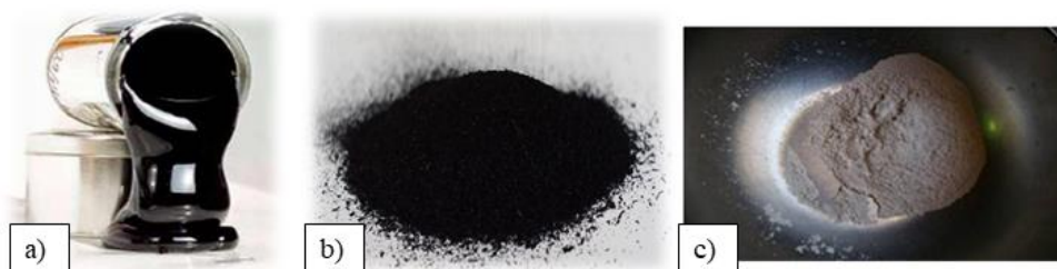
Figura 2.10- Constituintes da RAR a) asfalto, b) granulado de borracha e c) material de enchimento ( filler ) (modificado-Sousa et al. , 2012).
