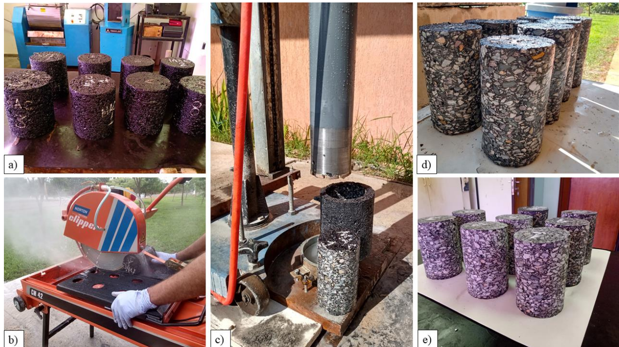
Figura 3.7- Produção dos corpos de prova: a) Corpos de prova após desmoldagem; b) Corte de topo e base do CP para a altura final de 150 mm; c) Coreamento dos CPs em serra copo diâmetro de 100 mm; d) CPs após a retirada no núcleo na serra copo; e) CPs após retirada de topo e base nas dimensões adequadas aos ensaios.
