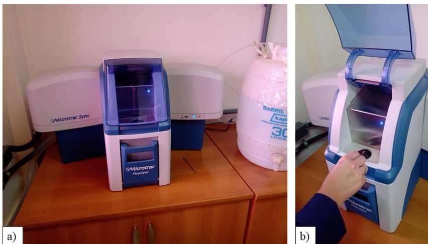
Figura 3.8 - a) Visão geral do equipamento granulômetro a laser da Microtrac; b) Carregamento da amostra no equipamento para a análise das partículas de RAR.
