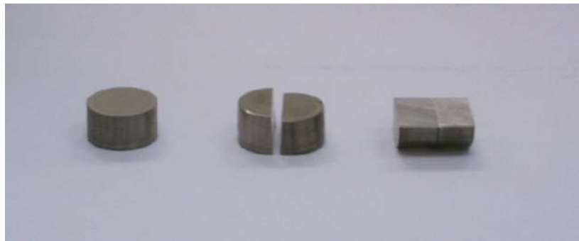
Figura 31: Seqüência de preparação das amostras para embutimento
