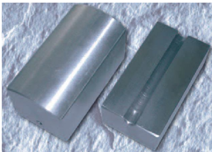
Figura 4: Matriz de aço ferramenta D2 (24)
