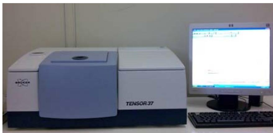
Figura 3.12. Espectrofotômetro no infravermelho próximo, da marca Bruker, modelo Tensor 37.
