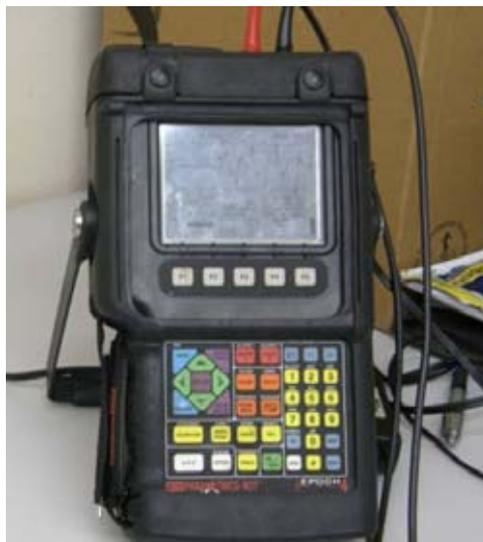
Figura 3.10. Equipamento de ultrassom, marca Panametrics modelo EPOCH 4.
