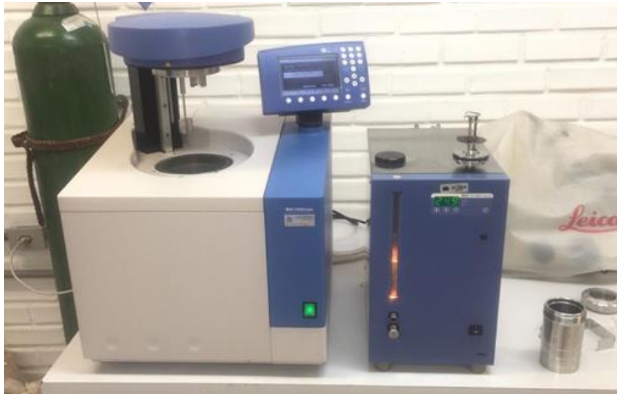
Figura 14. Bomba calorimétrica utilizada para determinação do Poder Calorífico.
