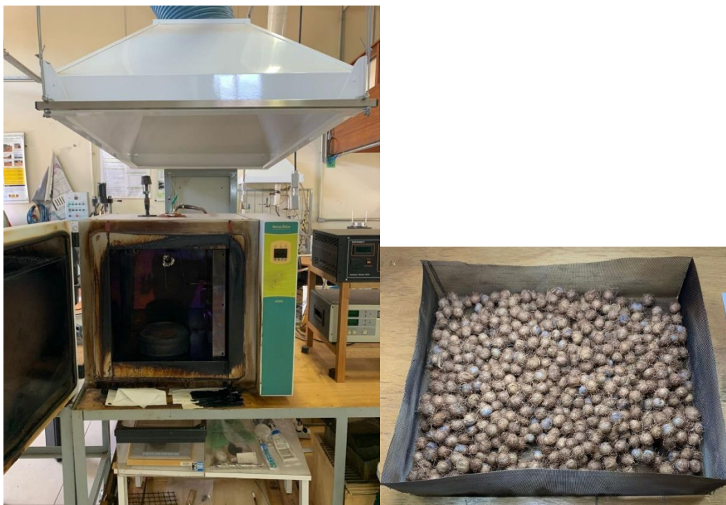
Figura 6. Forno de torrefação e amostras acondicionadas em uma bandeja telada de aço inox, respectivamente.
