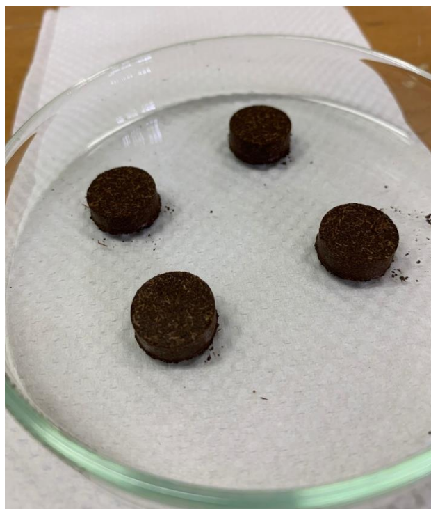
Figura 13. Peletes confeccionados a frio para ensaio de PCS.
