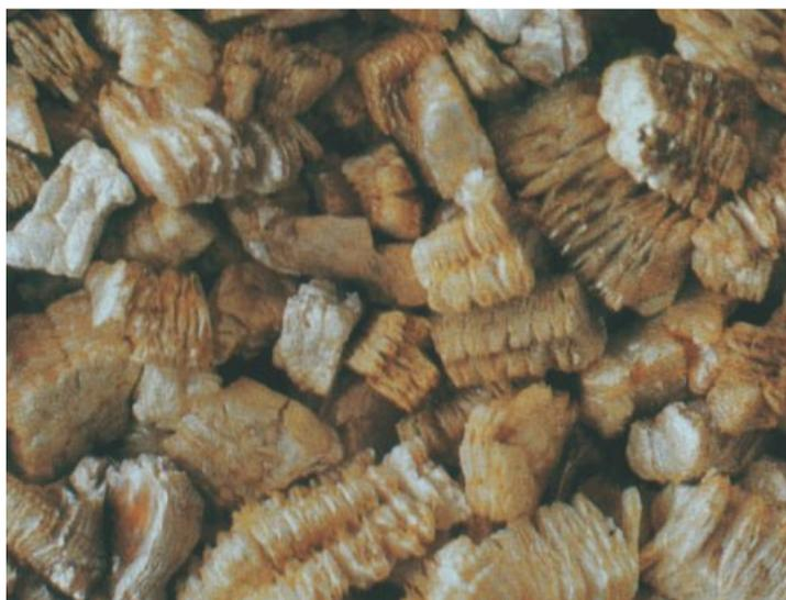
Figura 1.3 – Mineral vermiculita expandido.
