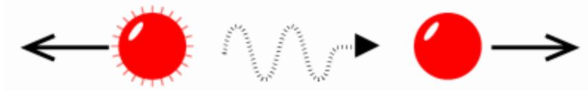
Figura 2.3 - Recuo do átomo livre na emissão e absorção de raios- $\gamma$ .
