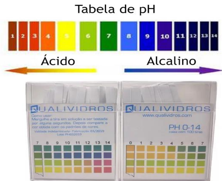
Figura 5: Papel indicador universal para medir pH
