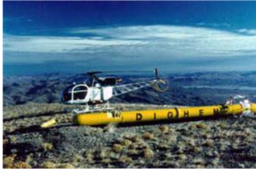
Figura 1.2: Sistema AEM com charuto (Geoterrex - dighem, 1999).
