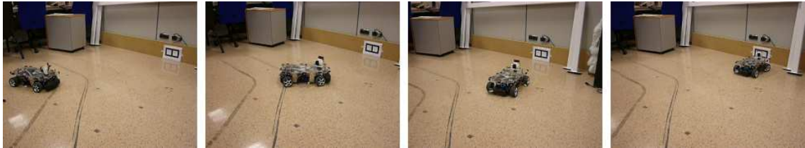
(b) Posicionamento de robô móvel em frente a um landmark [36]
