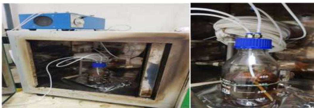
**Figura 24.** Imagem do reator PFR disposto em série com o vaso expensor inseridos dentro da estufa.
