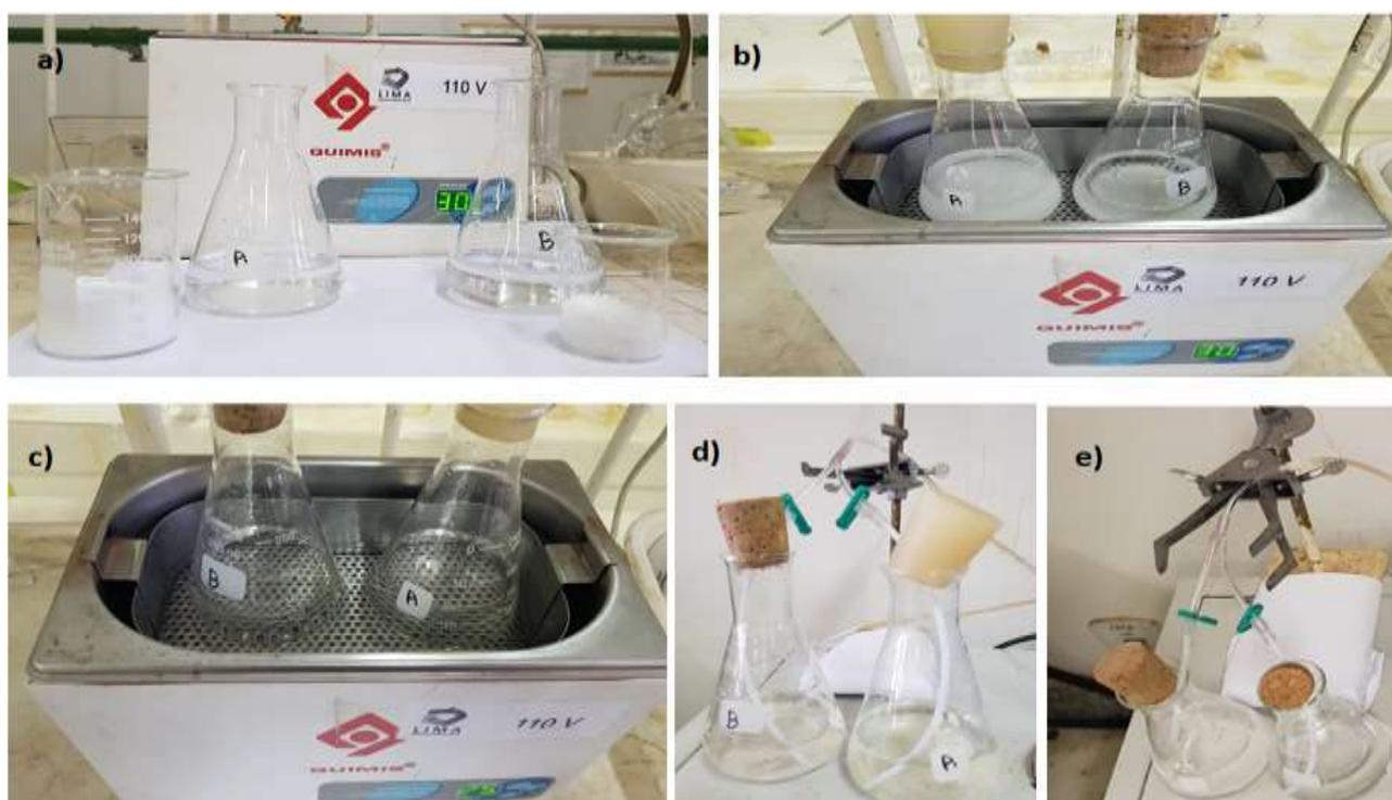
**Figura 16.** A) reagentes já pesados; B) reagentes logo após ser adicionada água destilada; C) reagentes após 5 minutos de banho ultrassônico; D) disposição dos reagentes para a reação; E) detalhe das válvulas (V-01 e V-02) e do misturador JY-01.
