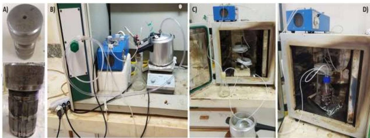
**Figura 21.** (A) reatores hidrotermais (23 mL e 120 mL), (B) panela de pressão utilizada com reator (CSTR) com aquecimento e agitação por chapa aquecedora e barra magnética, (C) tubulação de Teflon utilizada como reator PFR impulsionado por bomba peristáltica, (D) associação do reator tubular PFR com vaso expansor para acréscimo no tempo de residência do produto.
