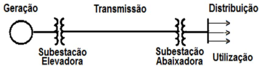
Figura 97 – Diagrama básico simplificado de um Sistema de Energia
