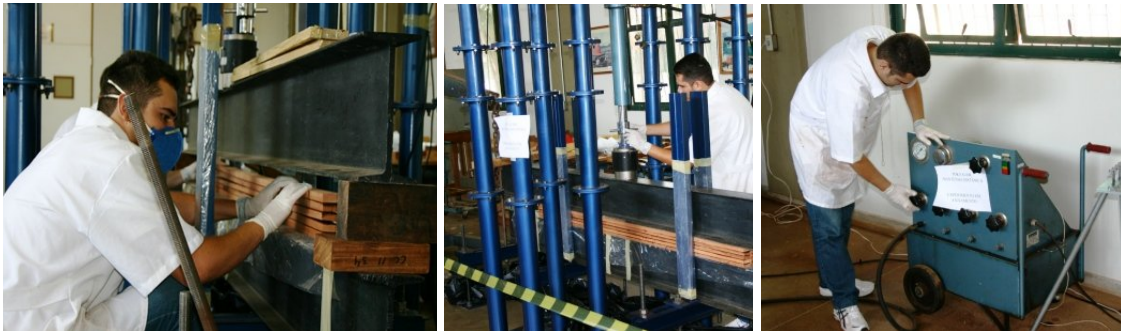
Figura 23. Posicionamento da viga, da célula de carga e aplicação de carga via sistema hidráulico.
