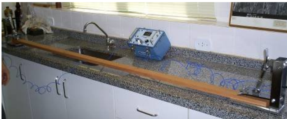
Figura 18. Esquema do ensaio de ondas de tensão, com o uso do equipamento stress wave timer .
