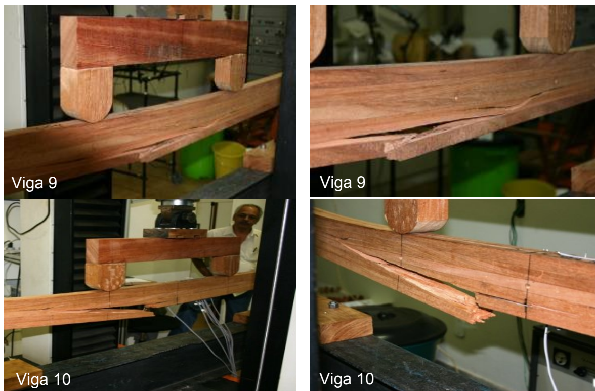
Figura 36 (continuação). Tipos de rupturas ocorridas nas vigas de MLC de números 9 e 10.
