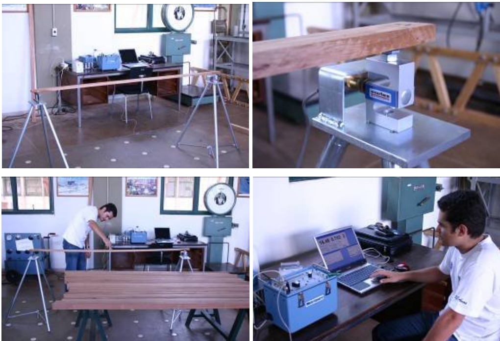
Figura 19. Esquema do ensaio de vibração transversal com o uso do equipamento Transverse Vibration E-Computer modelo E 340. Acima posicionamento da amostra e detalhe da célula de carga. Abaixo, indução da vibração na amostra e análise dos dados.
