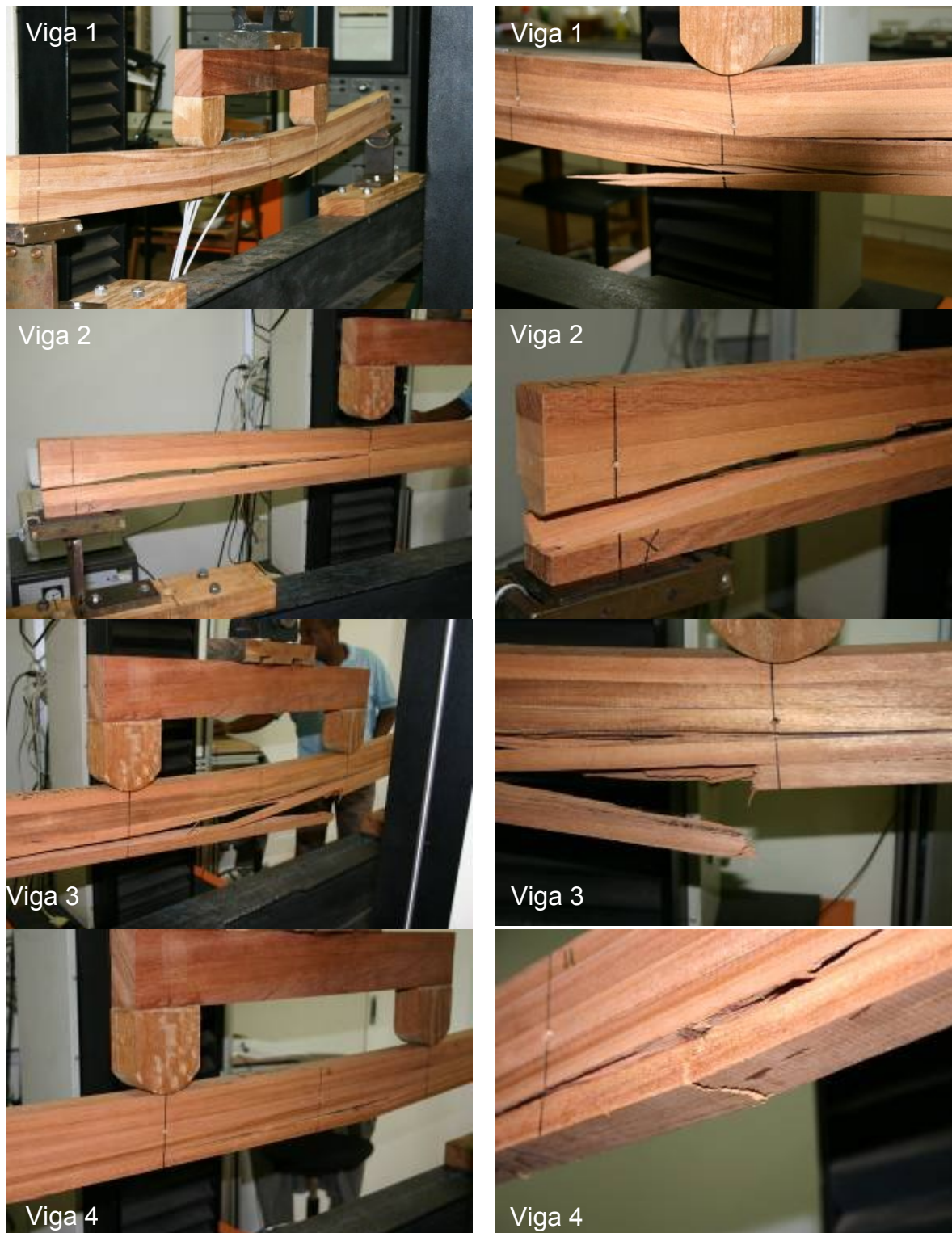
Figura 36. Tipos de rupturas ocorridas nas vigas de MLC de números 1 a 4.
