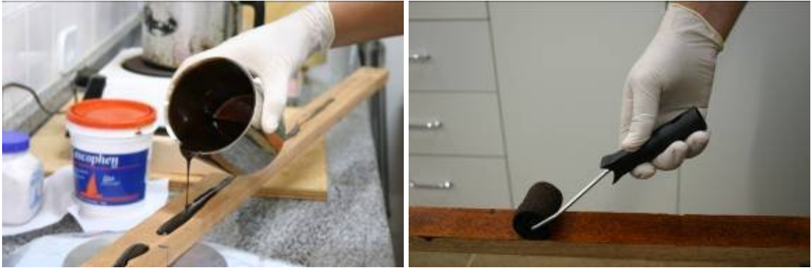
Figura 21. Aplicação do adesivo resorcinol formadeído nas lâminas.
