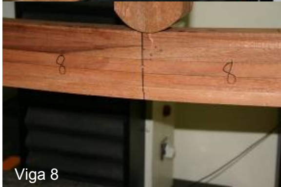
Figura 36 (continuação). Tipos de rupturas ocorridas nas vigas de MLC de números 5 a 8.
