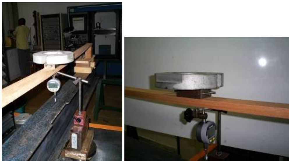
Figura 17. Esquema do ensaio de flexão estática segundo a norma ASTM D 4761 (2002).
