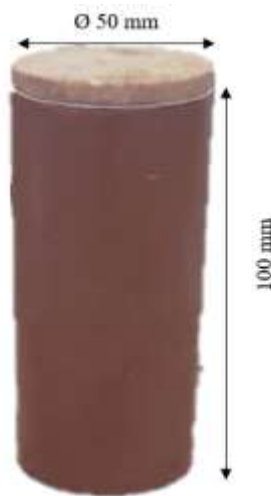
Figura 15. Corpo de prova para o Ensaio Triaxial
