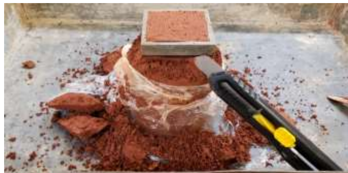
Figura 17. Preparação da amostra para o Ensaio de Cisalhamento Direto
