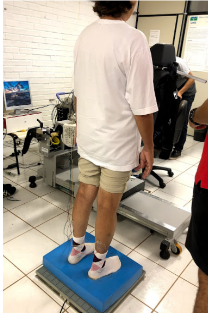
Figura 15. Voluntária sobre a plataforma de força. Coleta realizada sobre uma espuma de alta densidade posicionada sobre a plataforma de força AccuSway Plus (Advanced Mechanical Technologies, Inc – EUA).
