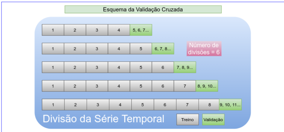
Figura 3.7 – Validação cruzada adota pela metodologia no processo de treinamento [Campos e Motta 2021].
