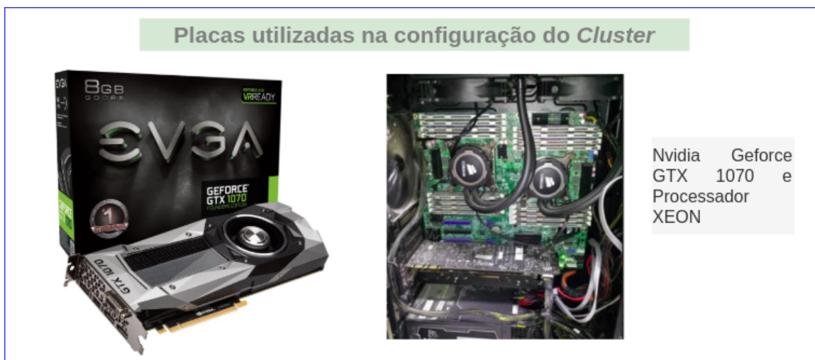
Figura 3.9 – Estação de trabalho e placas GPU com mais de 23000 núcleos CUDA.
