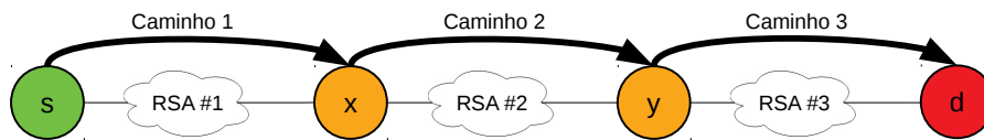
Figura 4.3: Exemplo de relação entre nós de articulação e o número de sub-caminhos de um conjunto P para uma requisição R\{s, d, b\} .
