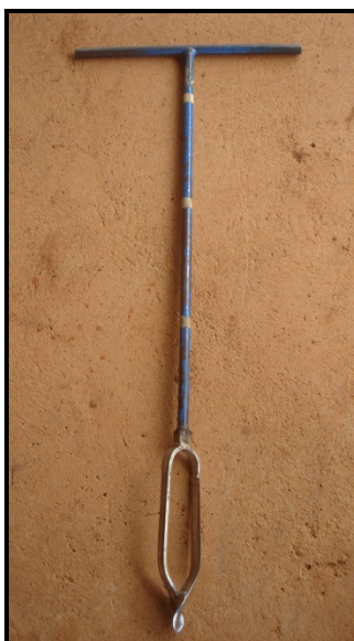
Figura 3.4. Trado tipo holandês utilizado para coleta das amostras de solo.
