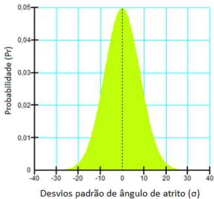
Figura 3.11 – Função de densidade de probabilidade para o offset do ângulo de atrito nas análises realizadas.
