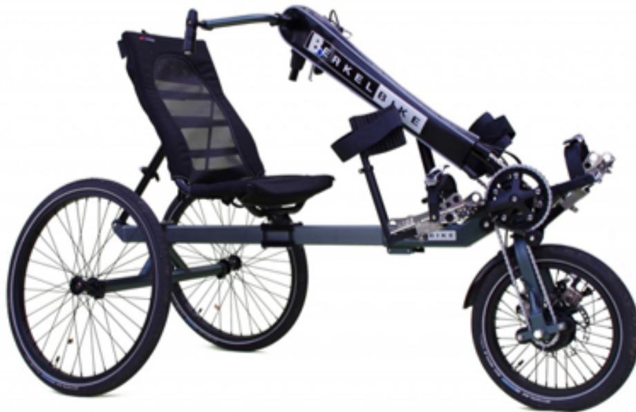
Figure 3.2: Modelo de trike Berkel Bike Pro da empresa Berkel Bike. Permite uso das mãos na propulsão
