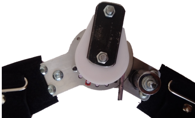
Figure 5.10: Protótipo projetado para \theta_i = 92^\circ e \Delta\theta = 20^\circ .
