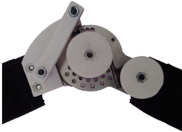
Figure 5.9: Protótipo projetado para \theta_i = 70^\circ e \Delta\theta = 42^\circ .
