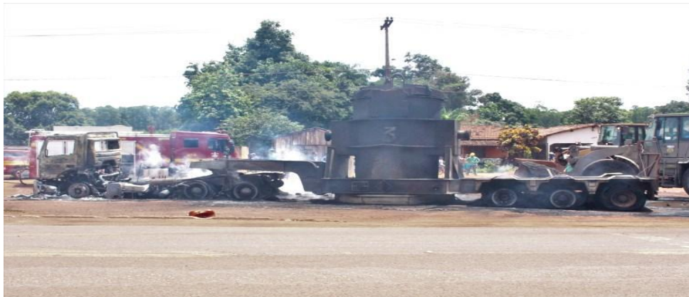
Figura 5. Caminhão que pegou fogo após vazamento de ferro líquido
