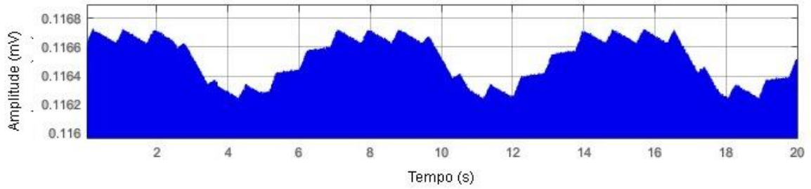
Figura 6.32 - Sinal de bioimpedância extraído a partir da onda semi seno após a saída da retificação do sistema proposto
