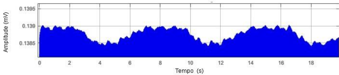
Figura 6.29 - Sinal de bioimpedância extraído a partir da onda semi seno após a saída da retificação do sistema convencional
