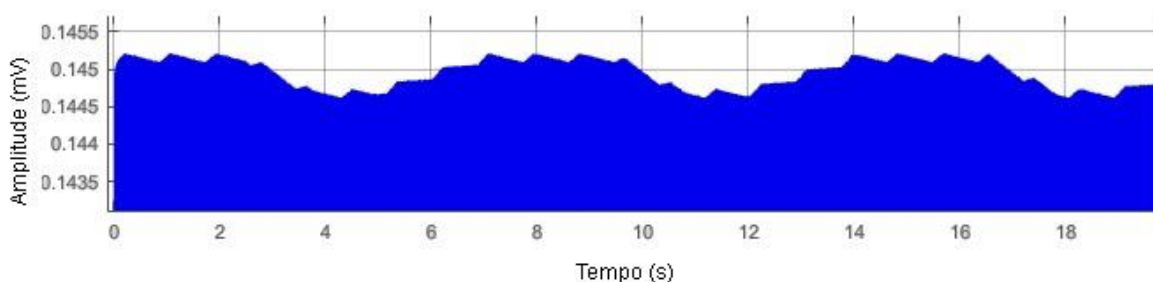
Figura 6.24 - Sinal de bioimpedância extraído a partir da onda semi quadrada após a saída da retificação do sistema proposto
