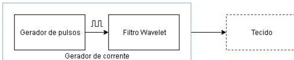
Figura 5.6 - Gerador da senoide gaussiana
