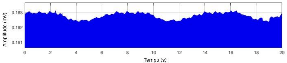
Figura 6.11 - Sinal de bioimpedância extraído a partir da onda quadrada após a saída da retificação no sistema genérico
