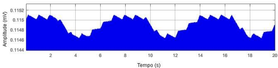
Figura 6.16 - Uma amostra da saída do demodulador do sistema proposto tendo como estímulo inicial a onda quadrada
