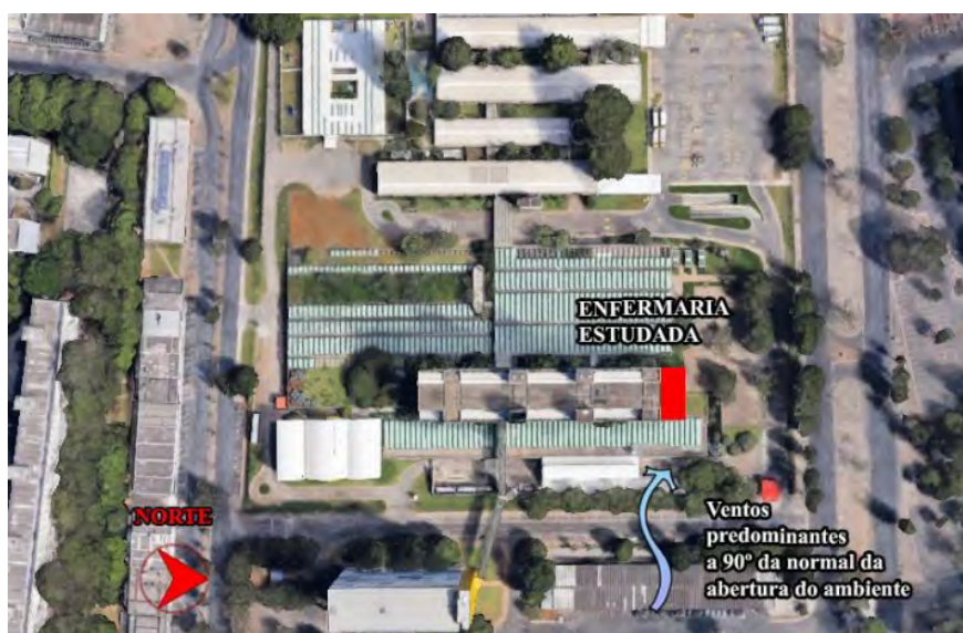
Figura 1: Fluxo de Ventos Predominantes nas fachadas do Bloco de Internação do Hospital Sarah Brasília.
