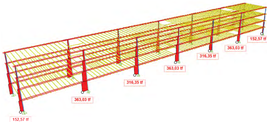
Figura 17 – Diagrama de esforços normais nos pilares do Bloco A e D. Fonte: Desenvolvido pelo autor, Programa SAP 2000
