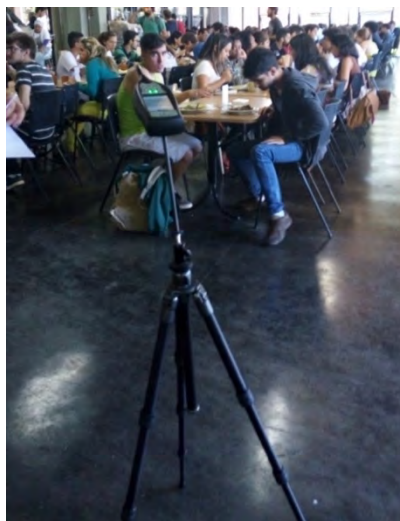
Figura 12: Equipamento Bruel Kjaer 2250 utilizado na medição do RU.
