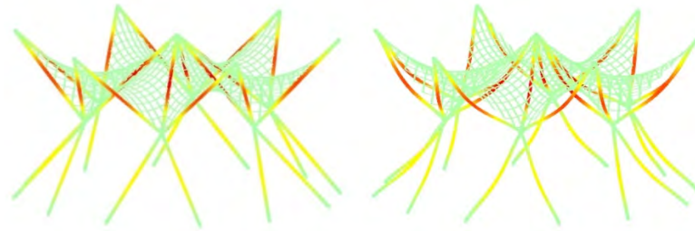
Figura 13: Estrutura em Bambusa Tuldoides, com 6 apoios, apresenta menor deslocamento máximo com o mínimo de apoios. Fonte: Autor
