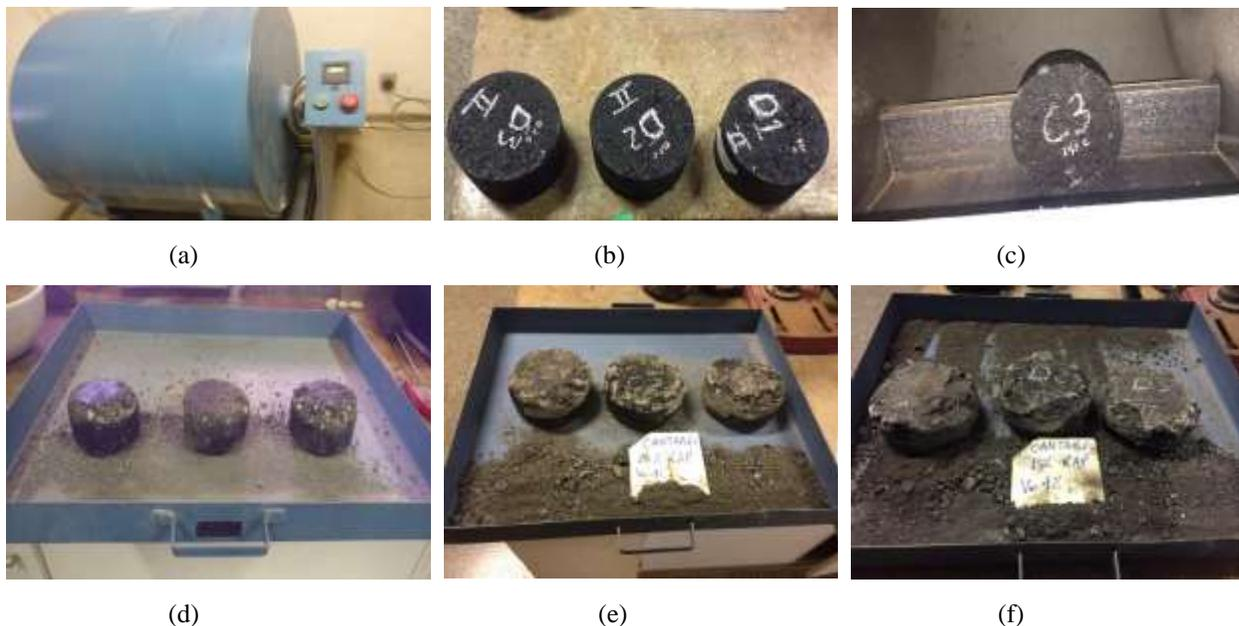
**Figura 3-19** Ensaio de desgaste cântabro (a) Equipamento Los Angeles; (b) CP's antes do ensaio; (c) CP no tambor; (d) CP's 100% RAP após desgaste cântabro; (e) CP's 25% RAP após desgaste cântabro; (f) CP's 45% RAP após desgaste cântabro (Autor 2020).
