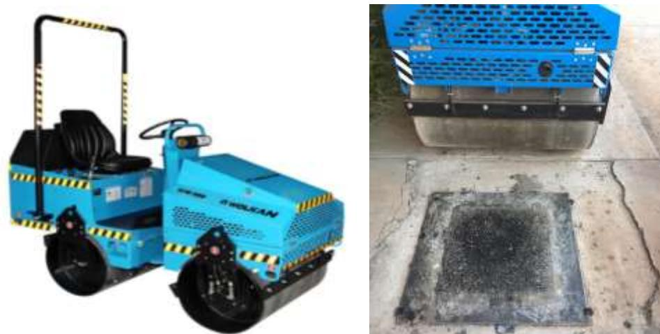
**Figura 3-12** Rolo compactador mecânico da WEBER MT modelo RCW 900 (Autor 2020).
