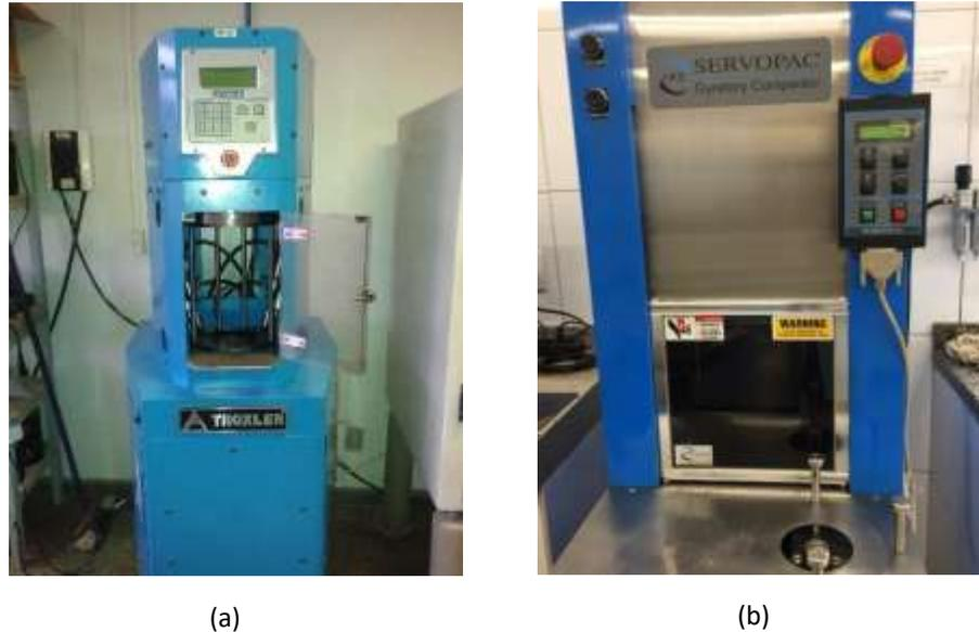
**Figura 3-7** Compactadores giratórios Superpave. (a) TROXLER-UnB; (b) IPC-UFG (Autor 2020).
