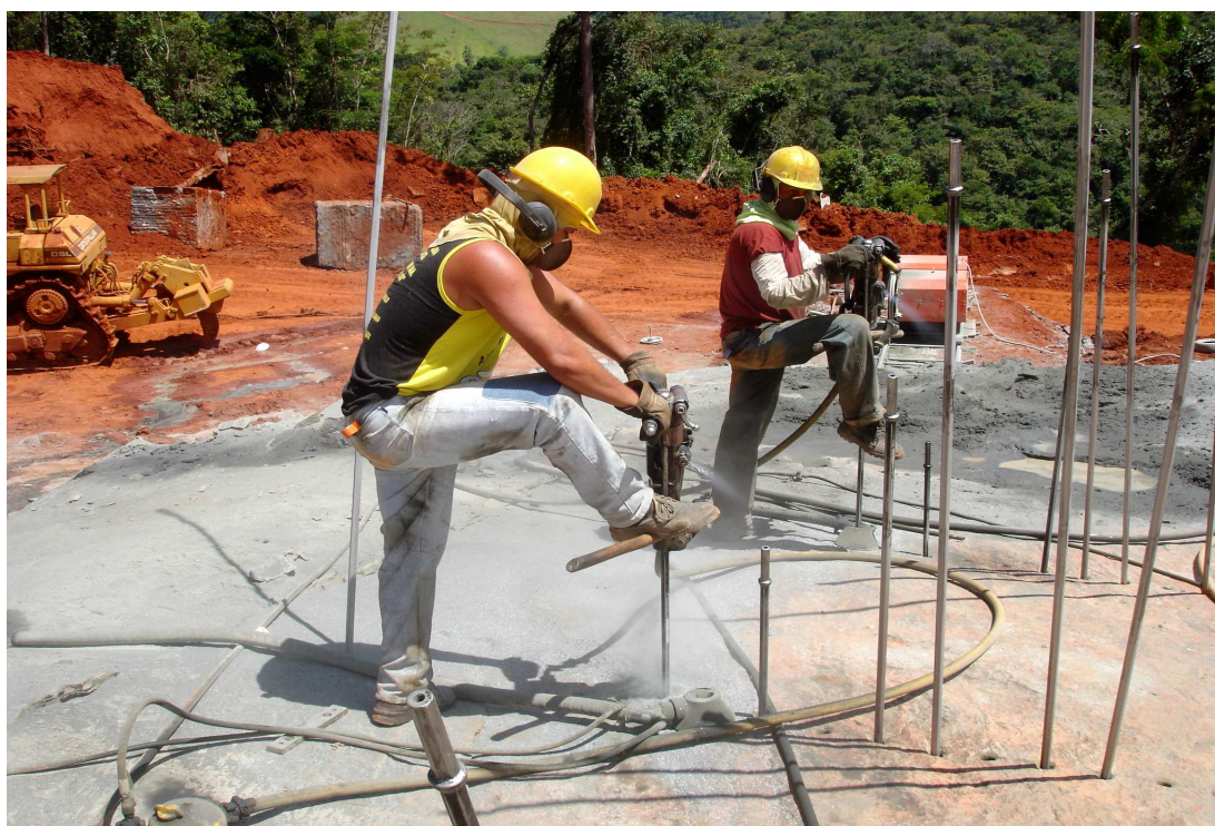
Foto 36: Uso do hidrojete em mina de granito ornamental da Granasa. Notar como o seu não uso, pelo primeiro operário, produz mais pó calcário.
