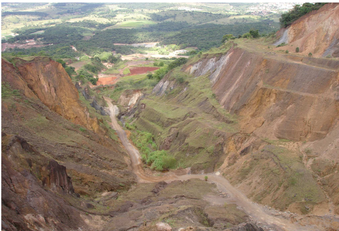
Foto 07: Mina Esperança, de minério de ferro, observando-se escorregamentos nos taludes.
