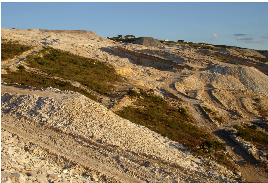
Foto 28: Mina de quartzito da G.A., em cava aberta. No alto, ao fundo, algumas casas da cidade de São Thomé das Letras.
