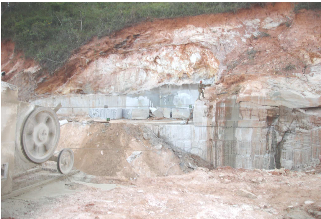
Foto 37: Mina de pedra-sabão da Pedra Azul, não detentora de AAF. À esquerda, equipamento de fio helicoidal cortando a rocha.
