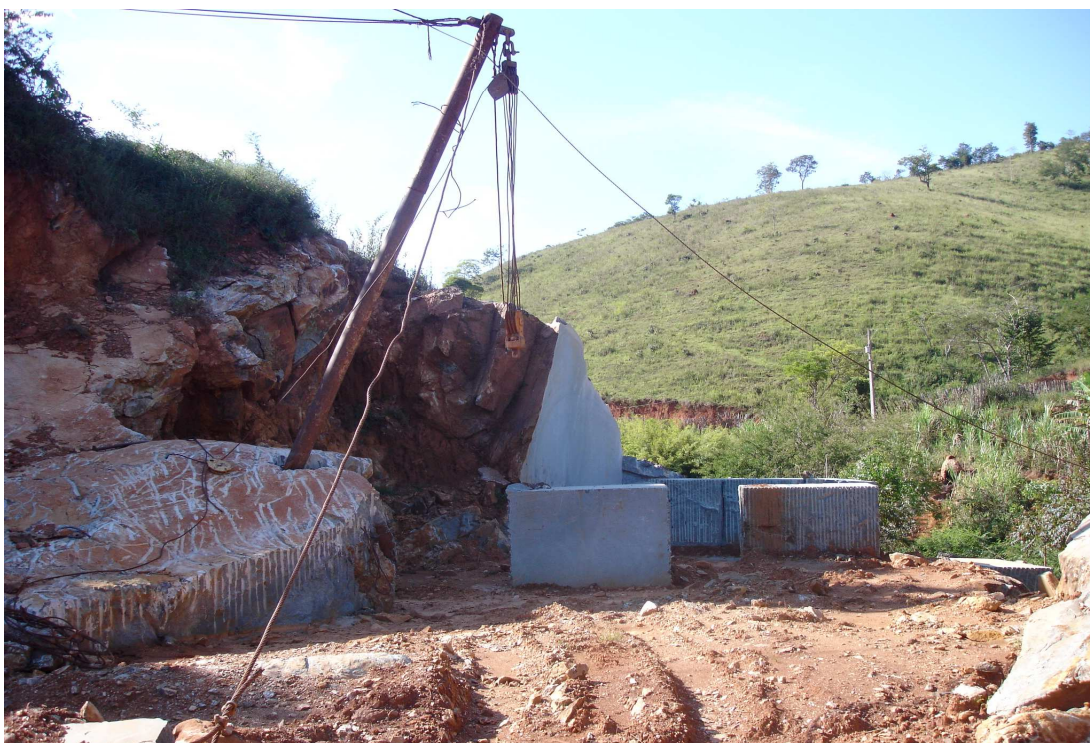
Foto 44: Mina de pedra-sabão da T. B. Loch, na Fazenda Chácara, Lamin. Observe-se o “pau-de-carga”, para içar os blocos até os caminhões.
