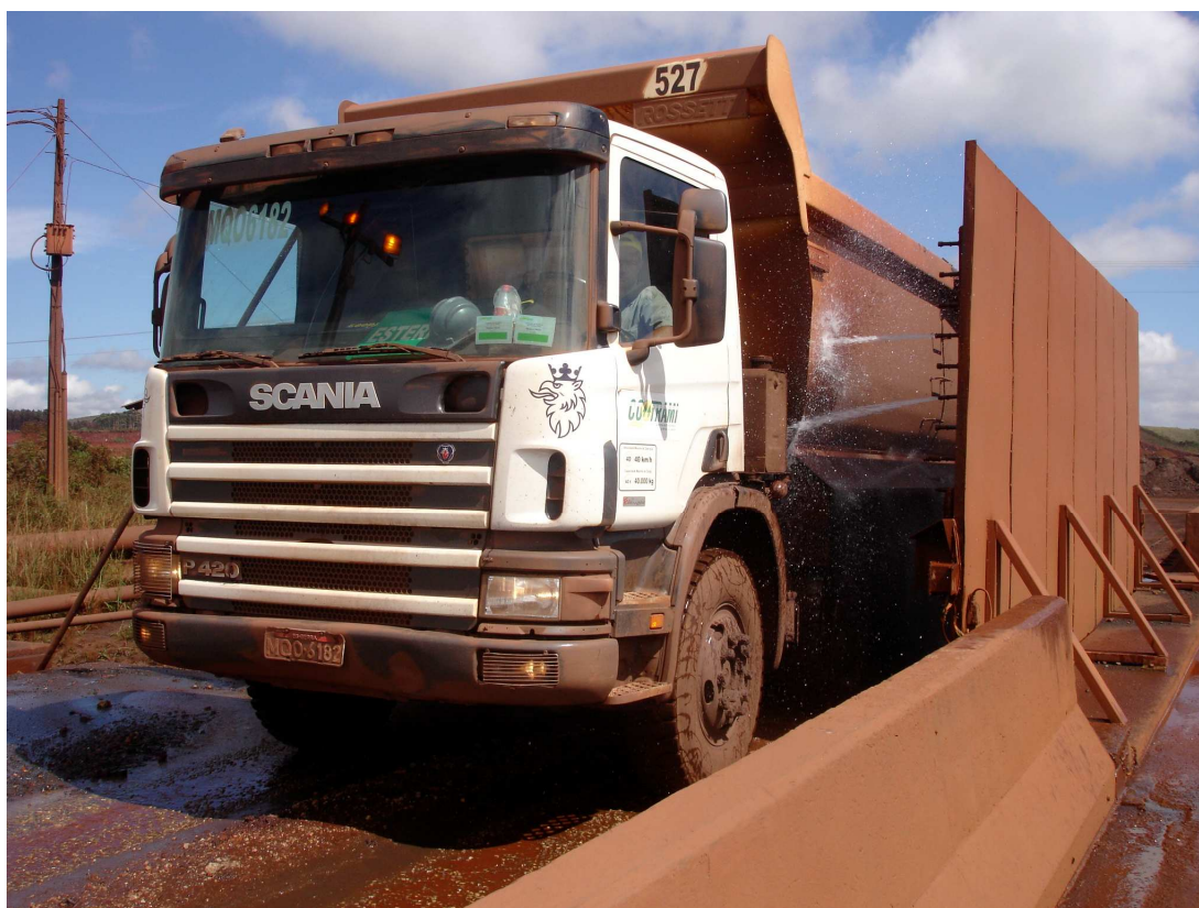
Foto 03: Lavador de caminhões e máquinas, instalado na saída da mina de minério de ferro de Capão Xavier.
