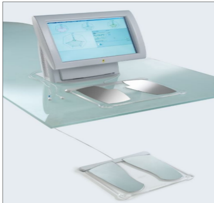
Figura 2 – Equipamento para medição da ESC, composto por painel de controle, uma placa de eletrodos para os pés e outra para as mãos. Extraída de Raisanen et al, 2014 (41)
