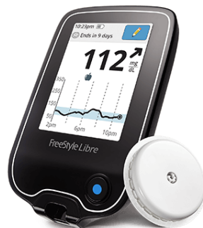
Figura 5 – Monitor e sensor de sistema flash de monitoramento da glicose utilizados para monitorização da glicose em fluido intersticial. Imagem extraída da internet: https://www.freestylelibre.us
