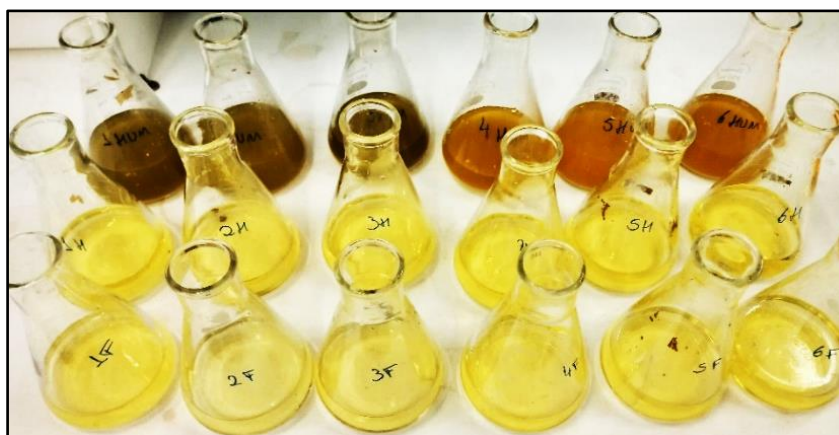
Figura 9. Amostras de substâncias húmicas para titulação antes da adição do indicador. Na primeira fileira está a fração ácido fúlvico (1F), na segunda ácido húmico (1H) e na terceira a húmica (1Hum). As amostras com numeração de 1 a 3 estão com matéria orgânica, e as amostras com numeração de 4 a 6 estão sem
