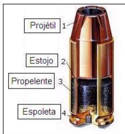
Figura 2. Composição de uma munição. Adaptado de Arouca 8 .
