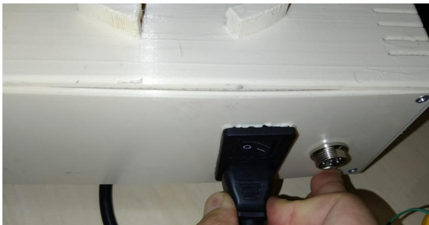
Figura 5.8: Flexão da tampa traseira ao se puxar o conector de tomada.
