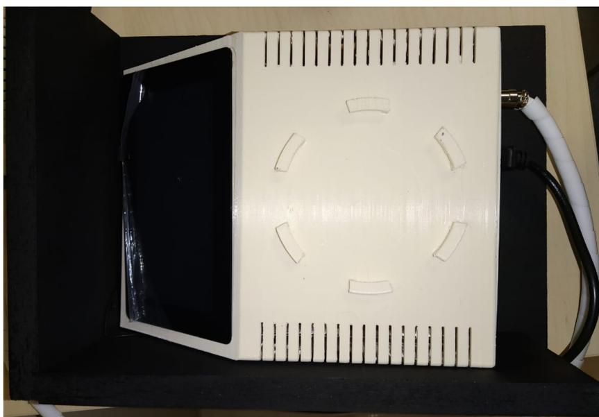
Figura 5.23: Posicionamento do gabinete no canto de ensaio para as medidas de temperatura de toque do gabinete.
