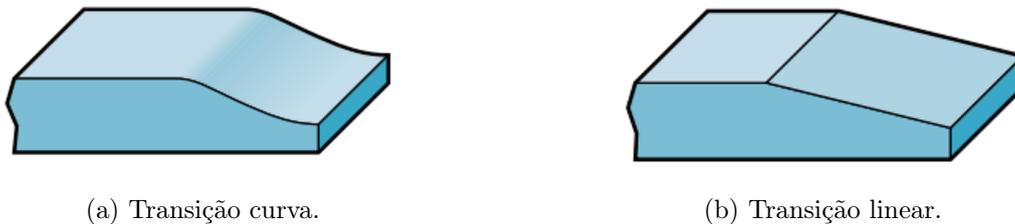
Figura 2.7: Duas maneiras de se executar a transição entre duas regiões de espessuras distintas. Retirado de (BAYER, 2000, p. 22)
