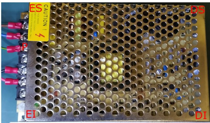
Figura 5.18: Locais onde foram efetuadas as medidas de resistência ao terra na MS-100-24.
