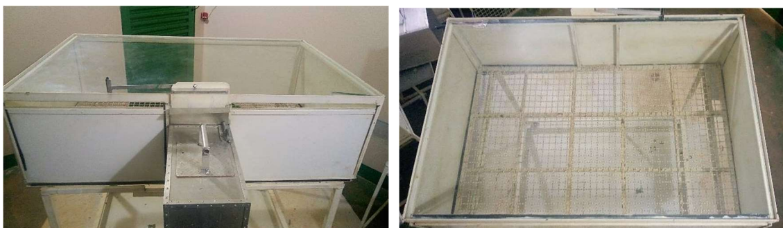
Figura 4.3. Fotografias do aparato do Campo Aberto utilizado nas sessões experimentais. À Esquerda : Vista lateral do aparato, com a caixa-transporte acoplada diretamente em frente a porta do tipo-guilhotina e evidenciando o teto e a parede (ao fundo) de vidro transparente; À Direita : Vista superior do aparato, evidenciando as três paredes de chapa de alumínio, o piso de tela metálica, e a porta do tipo-guilhotina. (Foto: Clarissa Vannuchi).
