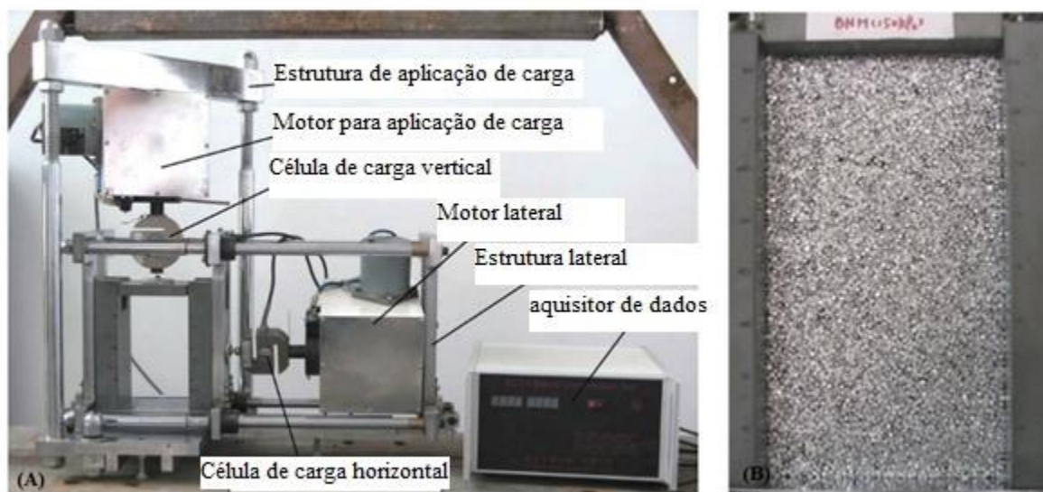
Figura 2.4 – (a) Ensaio Biaxial para calibrar o DEM (b) Amostra de solo idealizado constituída por partículas de alumínio (Fu et al. 2016)
