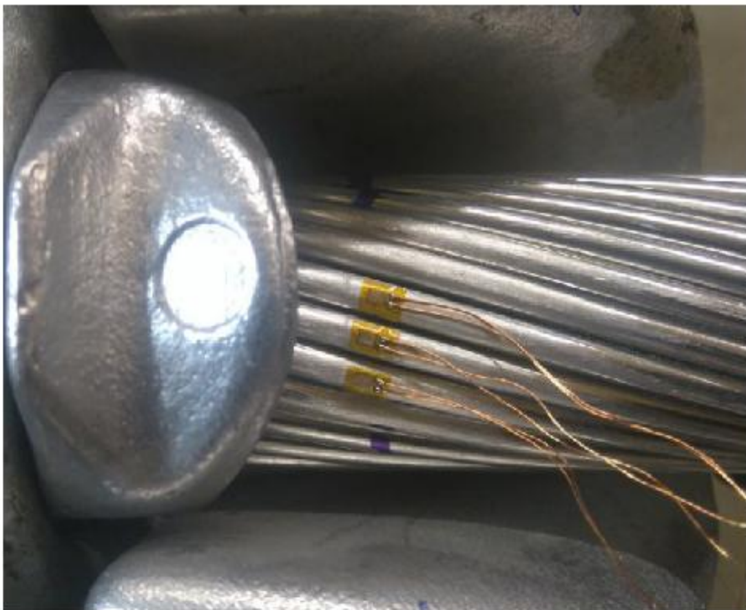
Figura 4.16 - a) Extensômetros colados em todos os fios de alumínio da camada externa do cabo condutor para realização dos ensaios estáticos; b) Extensômetros colados nos três fios mais altos e opostos ao UPC para realização dos ensaios dinâmicos.
