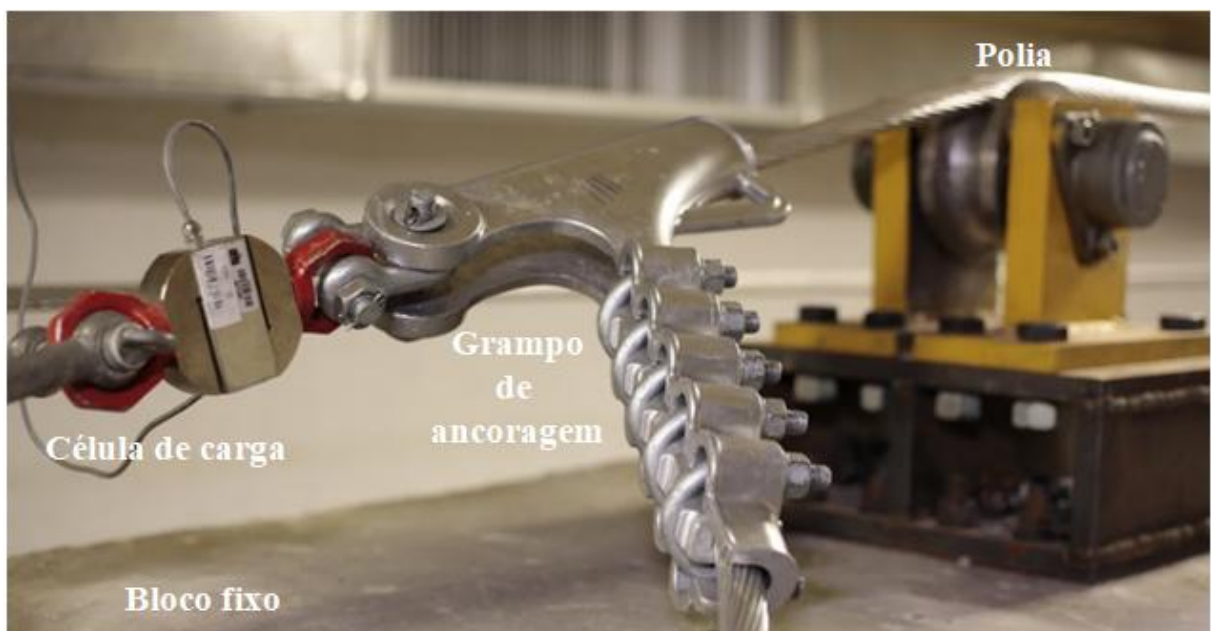
Figura 4.10 - Conexão da célula de carga através de um grampo de ancoragem.
