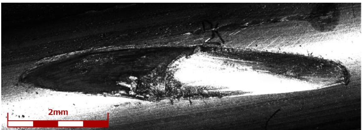
Figura 5.42 - Marca de contato entre fios do cabo condutor CAA TERN para H/w=1820 \text{ m} e Y_b=0,84 \text{ mm} a uma distância d_1=8,58 \text{ mm} do UPC.
