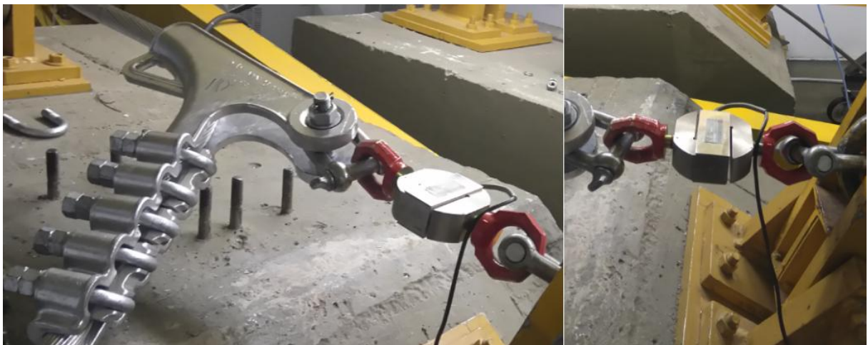
Figura 4.4 - Célula de carga CSR-5000 kgf.
