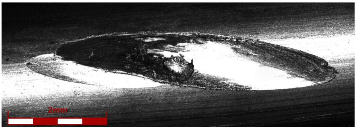
Figura 5.51 - Marca de contato entre fios do cabo condutor CAA TERN para H/w=2725 m e Y_b=0,78 mm a uma distância d_1=8,13 mm do UPC.
