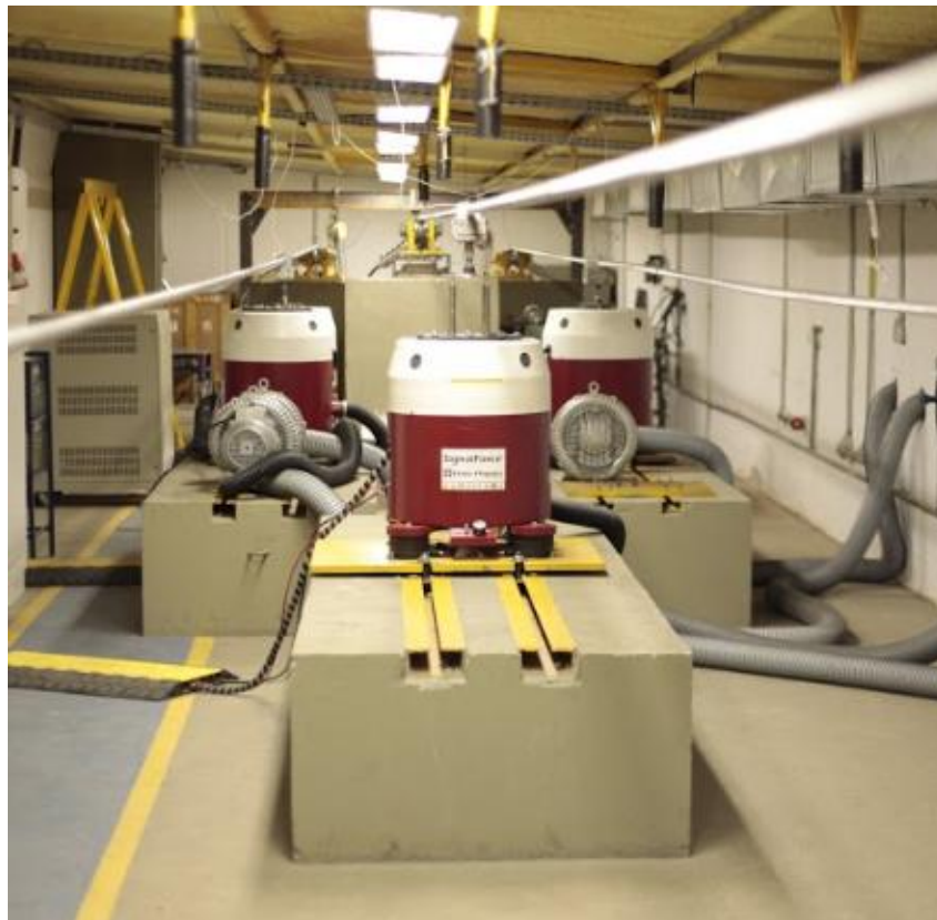
Figura 4.6 - Blocos fixos com trilhos para deslocamento do excitador eletromecânico.
