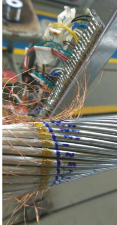
Figura 4.17 - Soldagem dos fios dos extensômetros.
