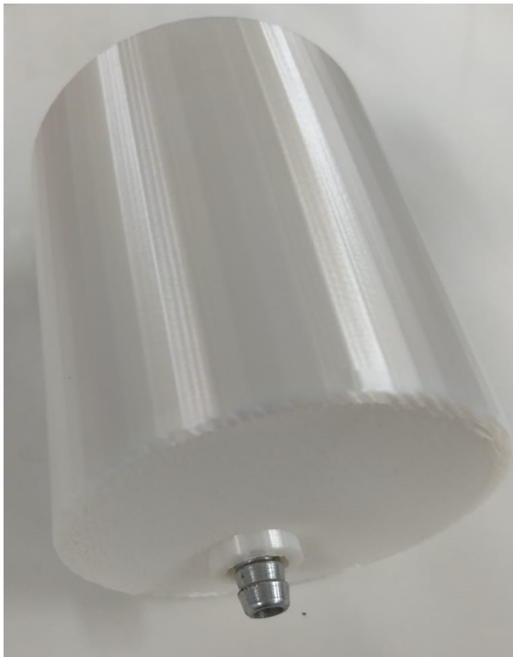
Figura 3.21: Visão externa da válvula esférica modificada após a missão.
