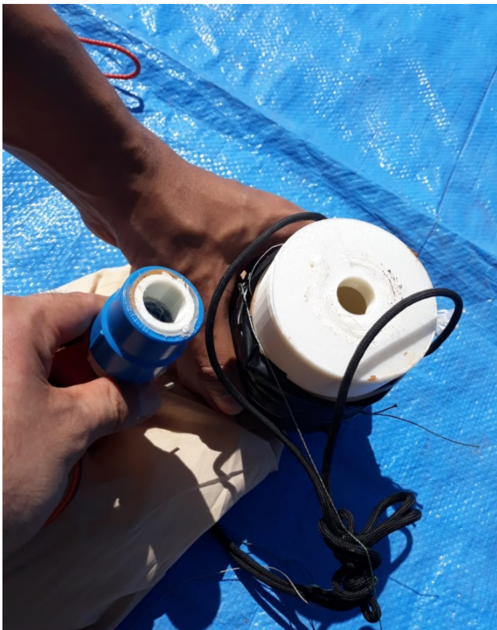
Figura 3.17: Bocal de PLA quebrado após a descida do balão cativo.
