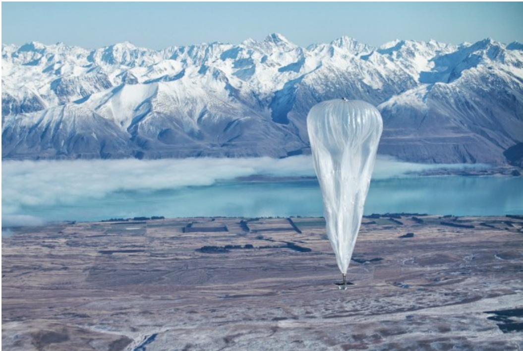
Figura 1.4: Um balão de pressão zero do Project Loon da Google. Fonte: wired.com
