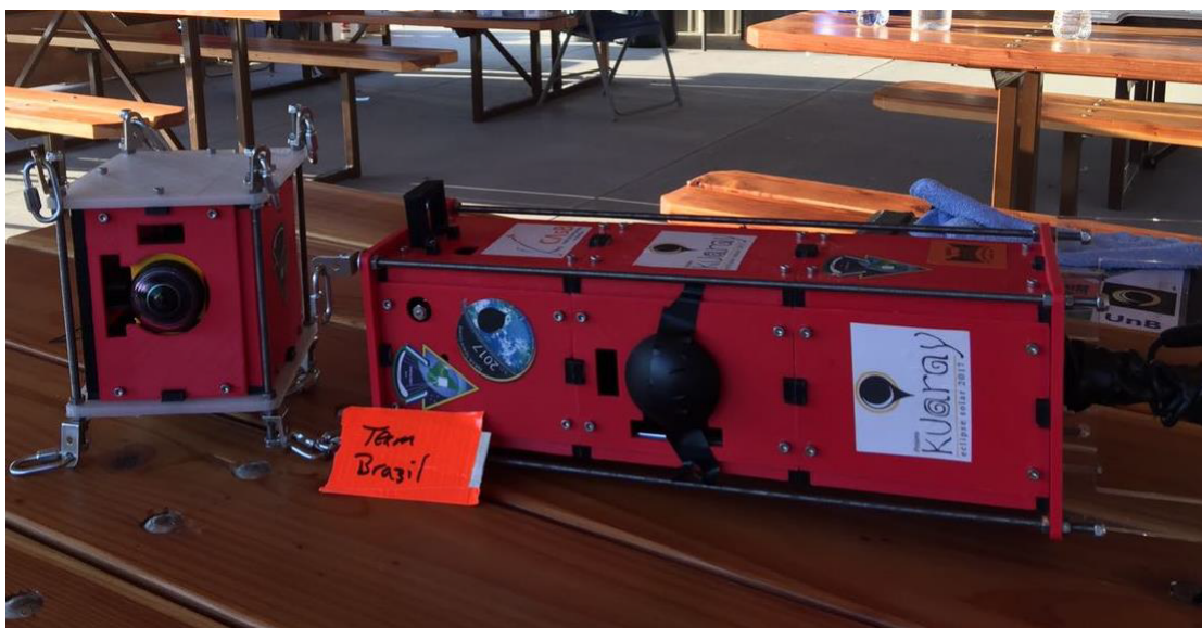
Figura 1.2: Plataforma do LAICAnSat-5 com um módulo 3U e outro módulo 1U, utilizado na missão para filmagem do eclipse solar total de 2017 em Idaho, EUA.
