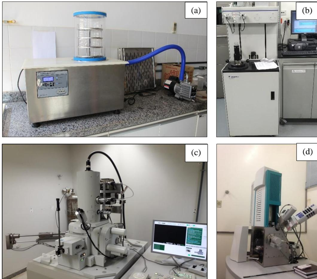
Figura 3.8 – (a) Liofilizador utilizado na técnica *freeze-drying*; (b) Equipamento para ensaio MIP (UniAndes); (c) Microscópio Eletrônico de Varredura (UnB); (d) Microscópio Eletrônico de Varredura (FURNAS).
